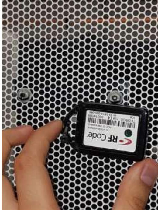
Figura 39: Sensor de temperatura y humedad
