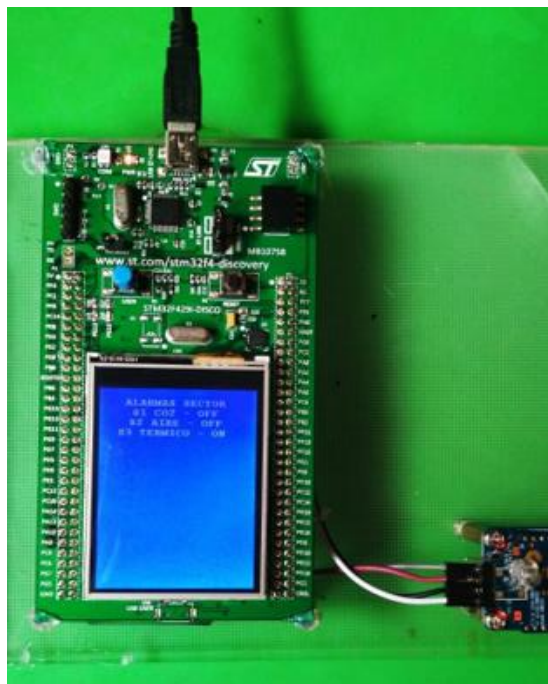
Figura 3. 26: Pruebas de recepción de datos en el LCD con información del sensor de temperatura.
