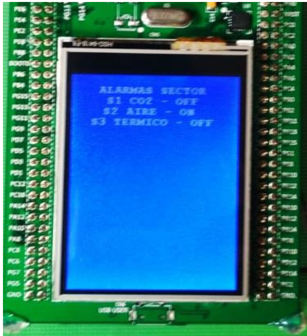
Figura 3. 29: Pruebas de envío y recepción de datos con el sensor de Calidad del Aire.
