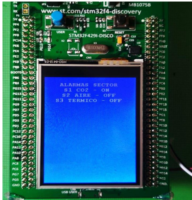
Figura 3. 27: Pruebas de recepción de datos en el LCD con información del sensor de CO2
