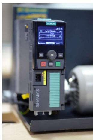
*Figura 3.3. Variador de frecuencia SINAMICS G120*
