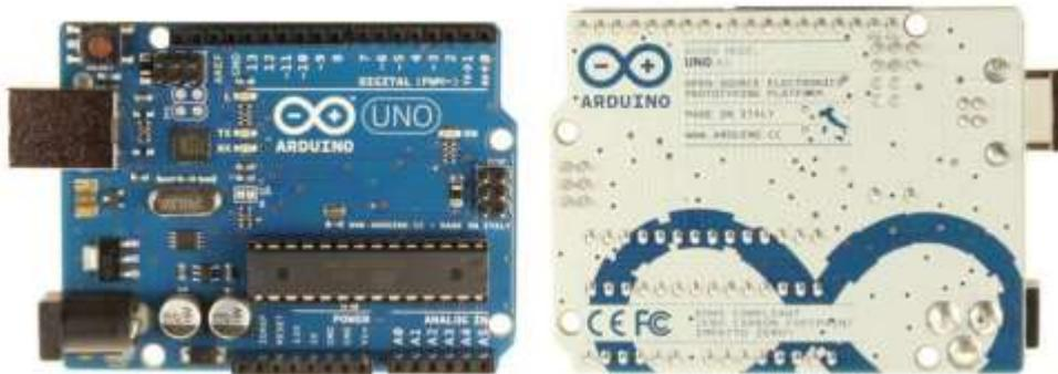
Figura 3. 1 Placa Arduino Uno
