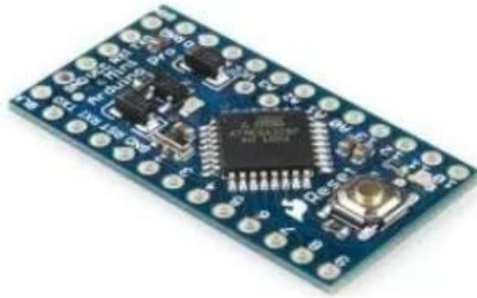
Figura 3. 17 Placa Arduino Pro Mini
