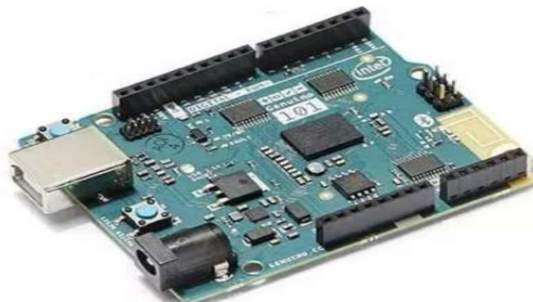
Figura 3. 4 Placa Arduino/Genuino 101
