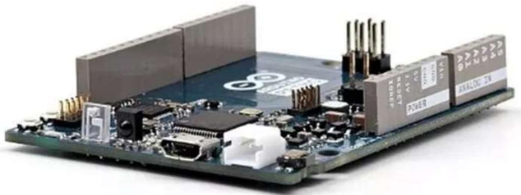
Figura 3. 23 Placa Arduino Primo
