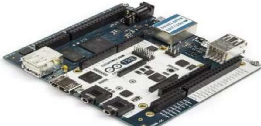
Figura 3. 3 Placa Arduino TRE
