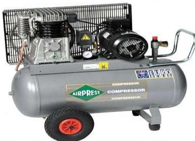
Figura 2. 6 Compresor de piston de un efecto o etapa
