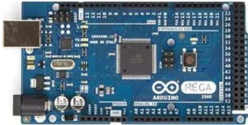
Figura 3. 10 Placa Arduino Mega
