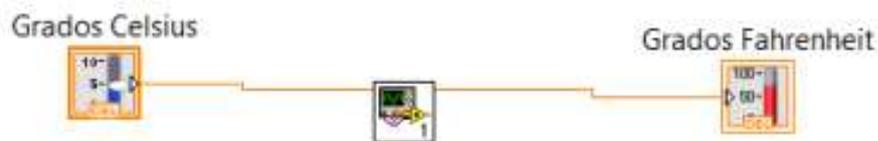
Figura 2. 7. Sustitución de todos los bloques seleccionados por un SubVI.
