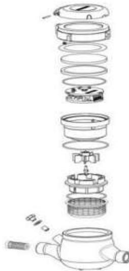
Figura 2. 19. Componentes del medidor de agua Chorro Múltiple.
