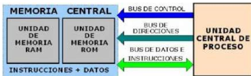
Figura 3. 5 Esquema de arquitectura Von Neumman
