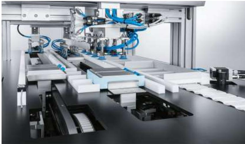
Figura 2. 6 Terminal de válvula FESTO
