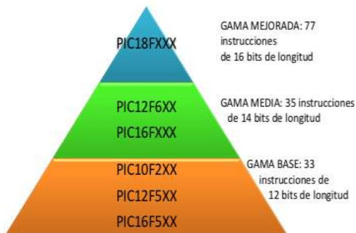
Figura 3. 2 Distribución de los modelos de PIC en las gamas
