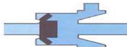
Figura 2. 19 Válvula de escape rápido
