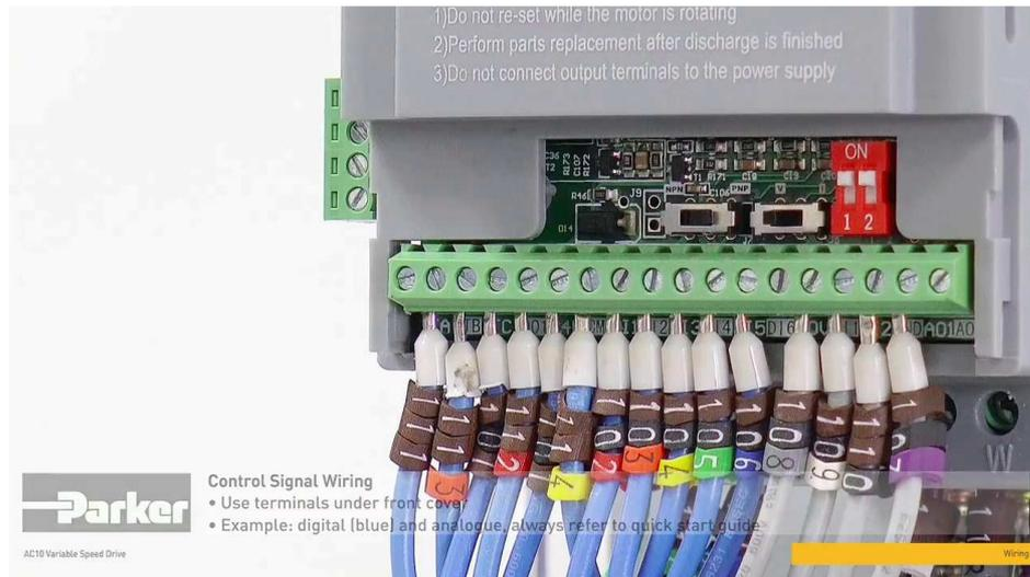
Figura 3.34: Bloque de control del variador AC10
