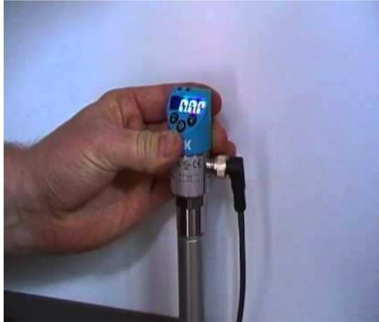
Figura 3.11: *Transductor de presión de un compresor de velocidad fija*
