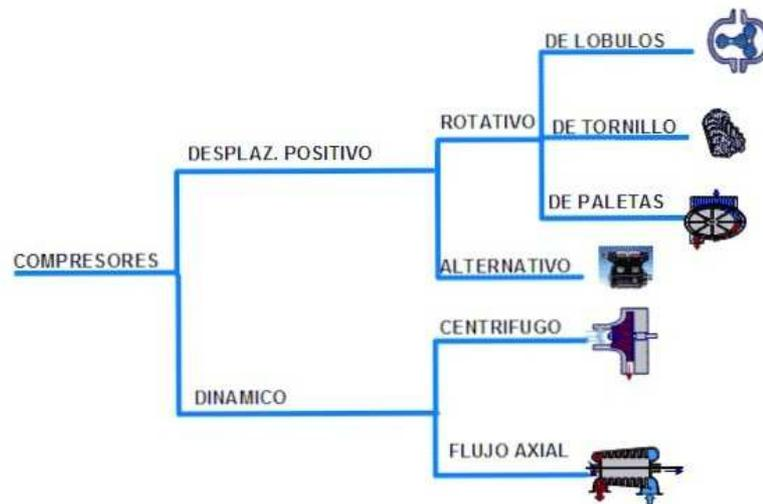
Figura 2.11: *Tipos de compresores de aire comprimido*
