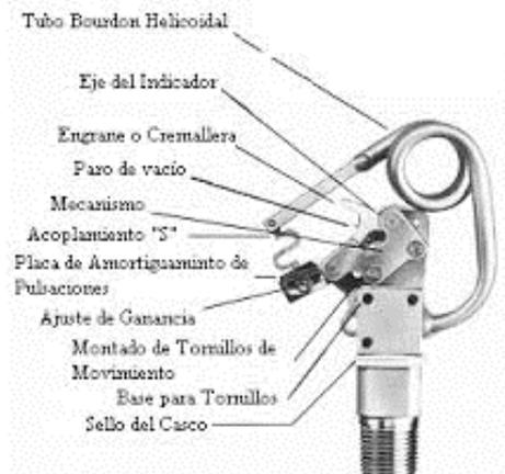
Figura 2.5: Manómetro de Bourdon
