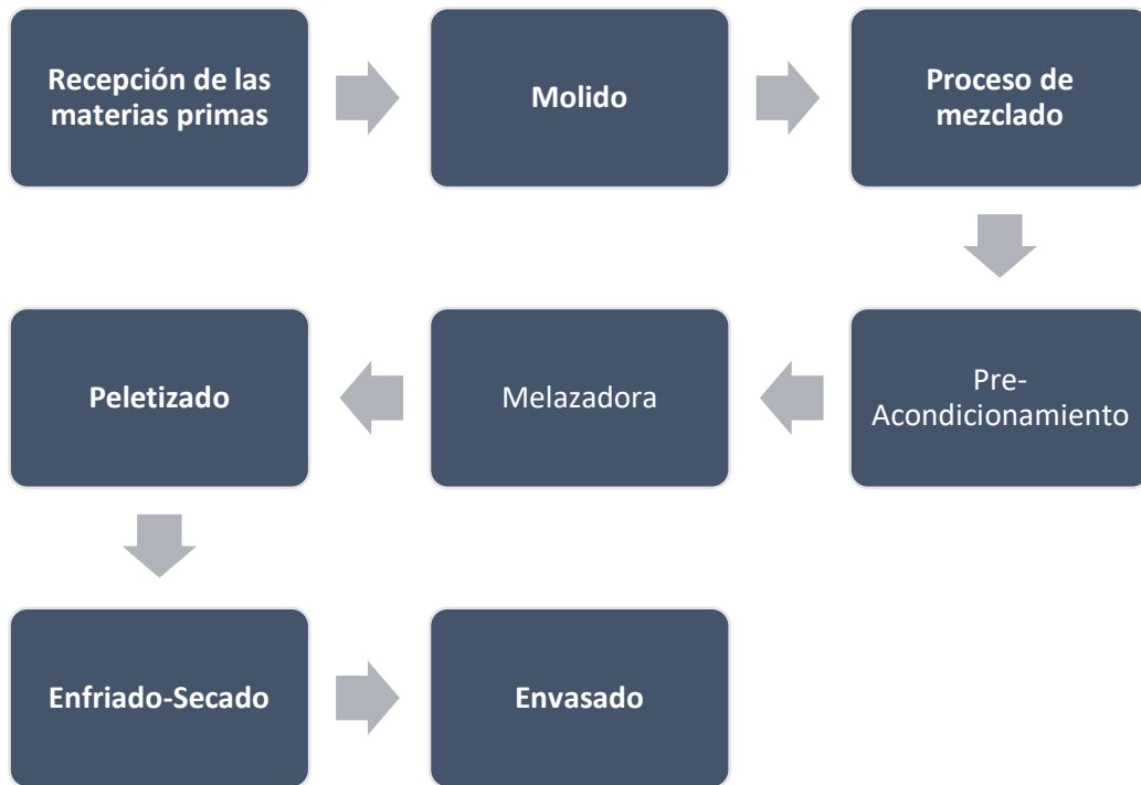
Gráfico 2. Diagrama de flujo de pellets
