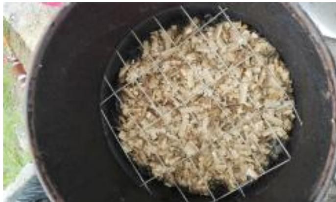
**Figura 3. 21.** Preparación del material filtrante con carbón y aserrín.
