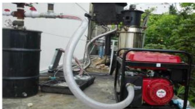
**Figura 3. 25.** Conexión desde la unidad conductora de gas hasta la admisión del motor
