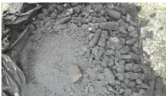
**Figura 3. 20.** Ceniza removida desde el puerto de ceniza del gasificador
