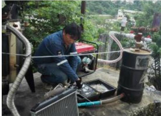
**Figura 3. 17.** Medición de presión diferencial
