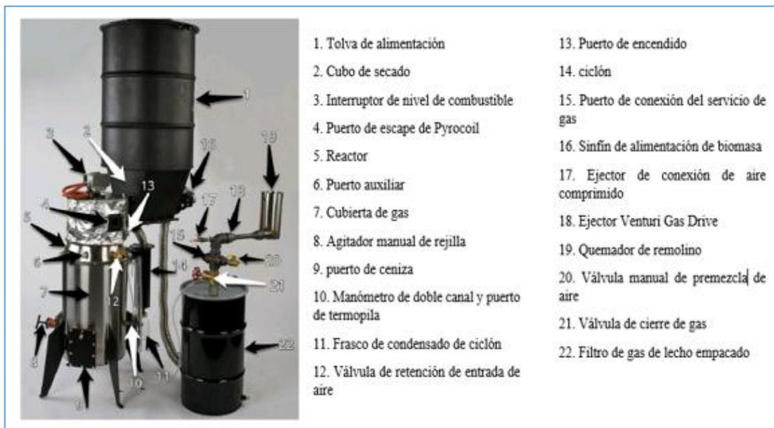
**Figura 3. 6.** Elementos del Gasificador GEK TOTTI
