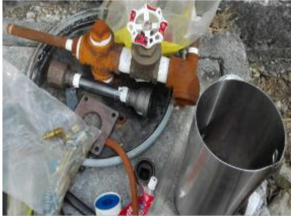
Figura 3. 2. Venturi, ejetor de aire comprimido, quemador
