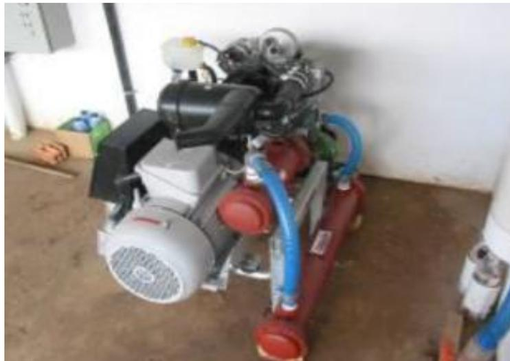
**Figura 2 24.** Motor a gasolina acondicionado para consumir biogás
