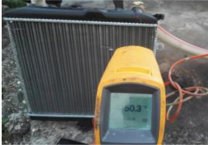
**Figura 3. 23.** Medición de temperatura en la salida del gas del radiador.
