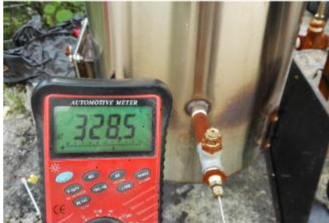
**Figura 3. 13.** Temperatura inferior en la zona de reducción
