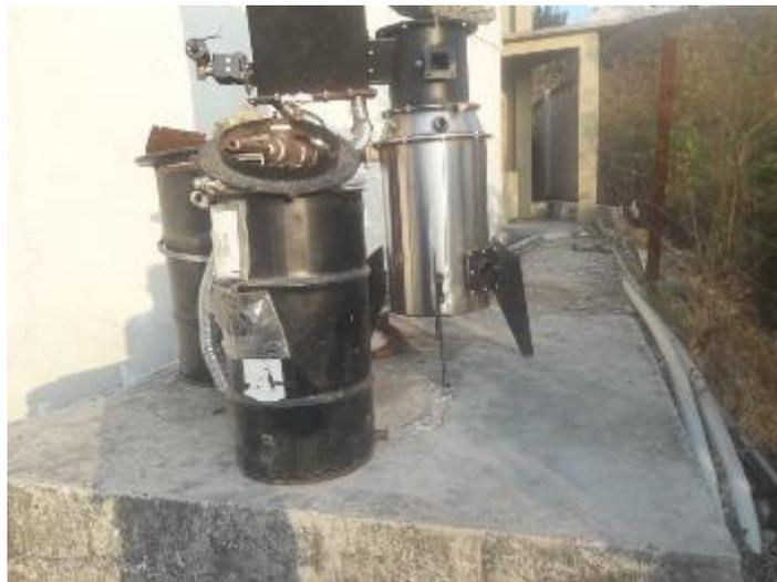
**Figura 3. 1.** Gasificador Downdraft GEK
