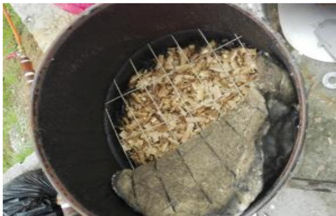
**Figura 3. 22.** Estado de los filtrantes luego de pruebas en el filtro de lecho
