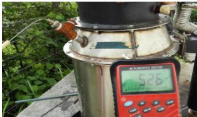
**Figura 3. 12.** Temperatura superior en la zona de reducción
