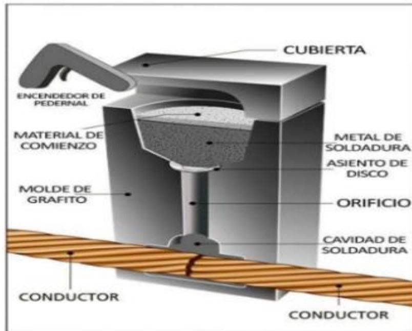
**Figura 20 Soldaduras exotérmicas**
