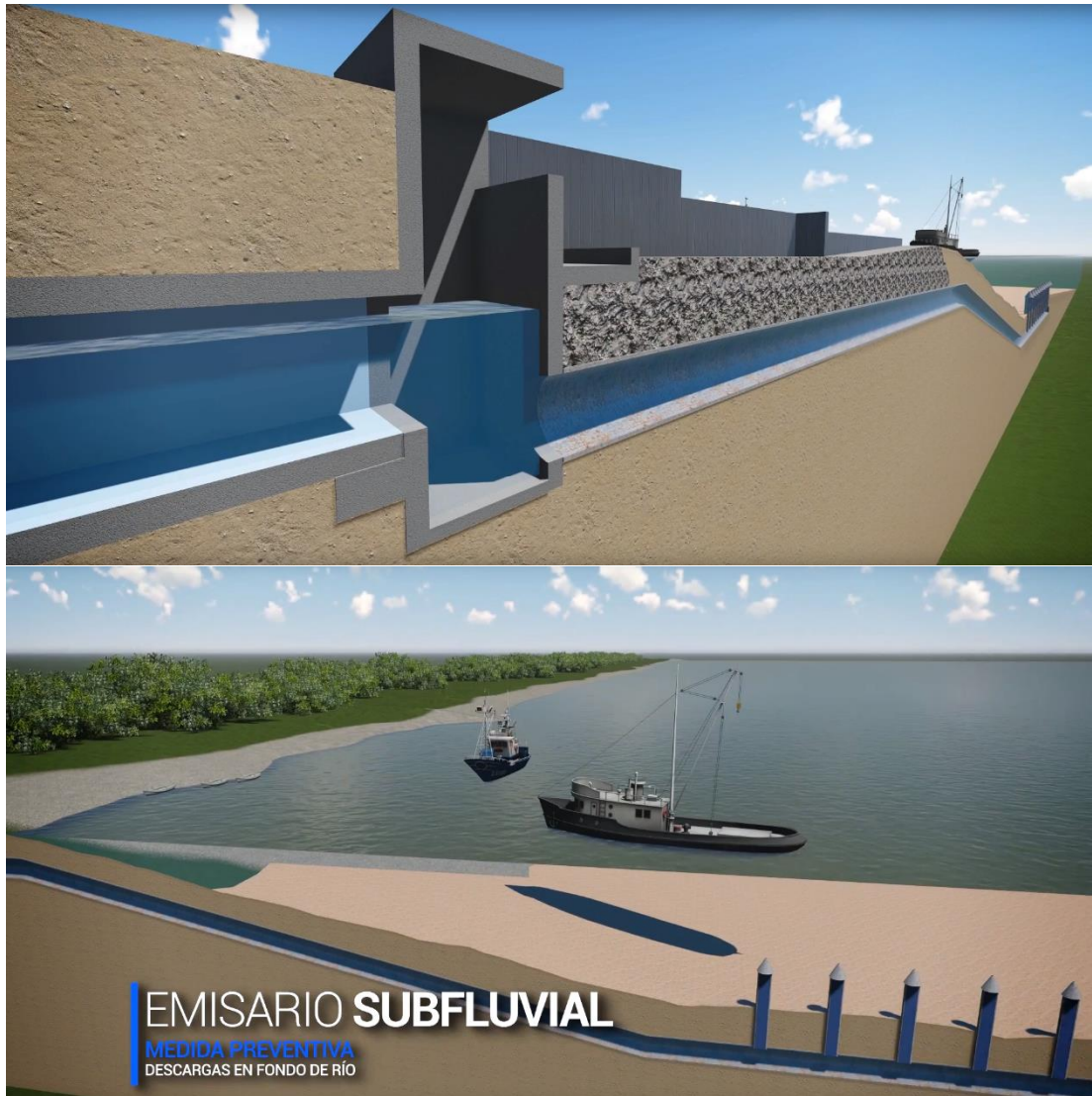
Figura 3. 10 Emisario subfluvial. Fuente: (Secretaría del Agua, 2017)
