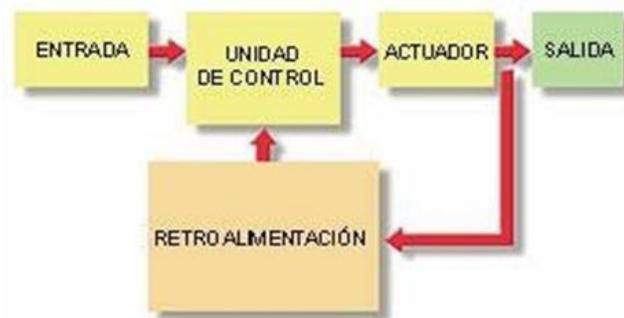
Figura 2. 48 Diagrama de bloques de lazo cerrado
