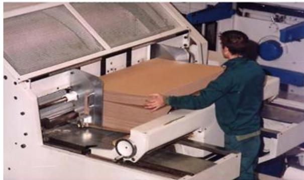
Figura 3. 4 Alimentador de láminas de cartón corrugado
