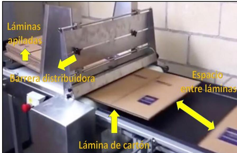
Figura 4. 1 Alimentador automático del cartón corrugado
