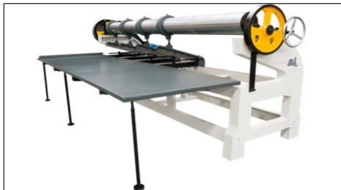
Figura 3. 7 Ranuradora tipo caimán manual
