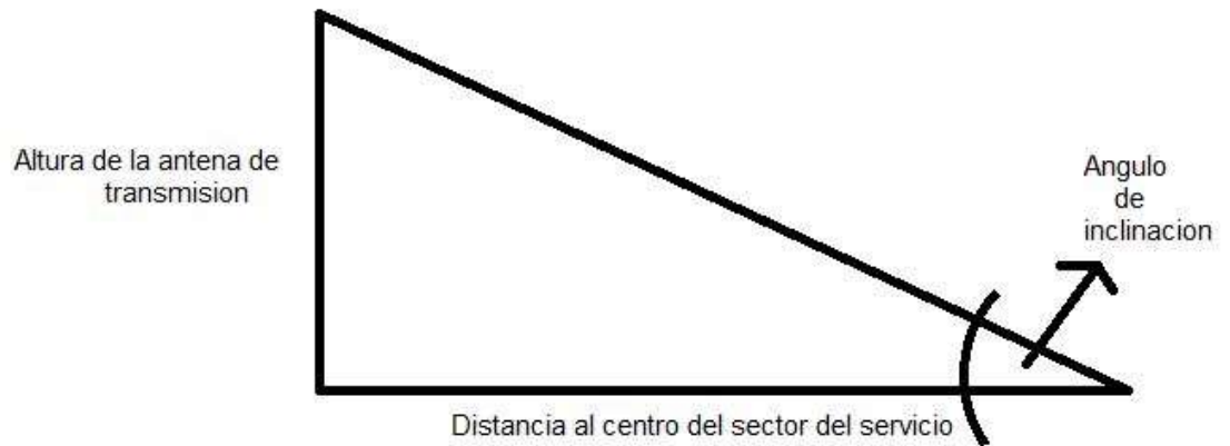
Figura 3.15: Calculo del ángulo de inclinación de la antena de transmisión
