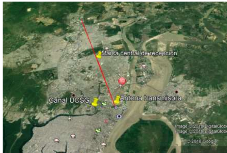
Figura 3.13: Trayectoria del radio enlace del canal UCSG
