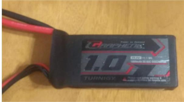
Figura 3. 4: Batería marca Turnigy de 11.1 V
