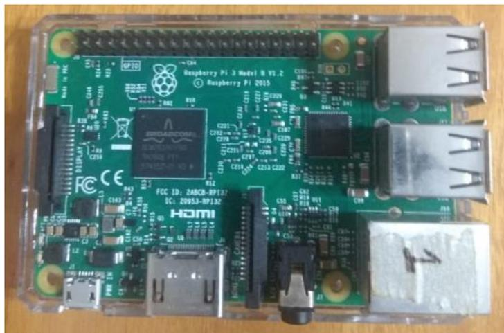
Figura 3. 1: Raspberry Pi 3 Modelo B utilizada en el prototipo
