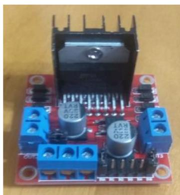
Figura 3. 5: Controlador de Motores L298N
