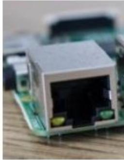
Figura 2. 5: Puerto ethernet para conexión a internet
