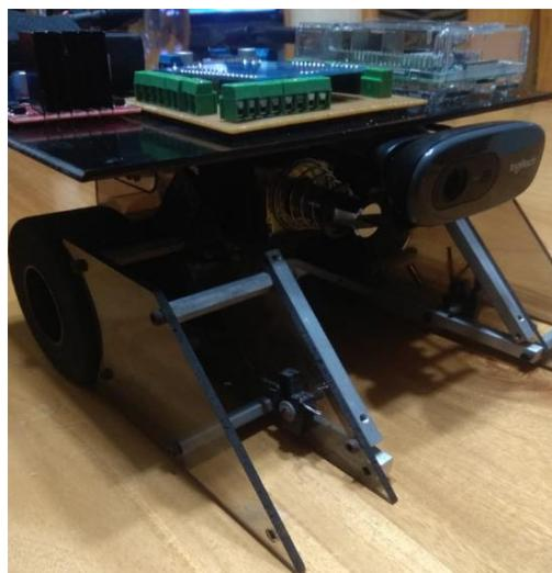
Figura 3. 23: Colocación de los componentes del prototipo
