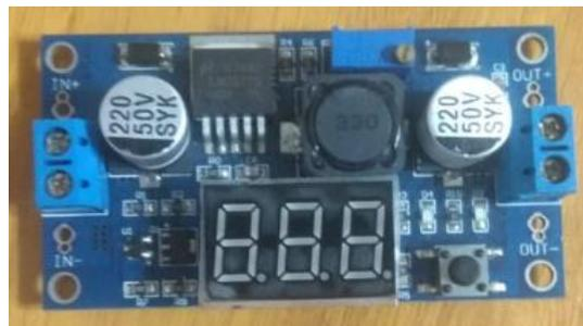
Figura 3. 7: Modulo Regulador de Voltaje DC
