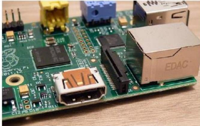
Figura 2. 3: Puerto HDMI de la tarjeta Raspberry Pi
