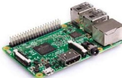
Figura 2. 15: del modelo Raspberry Pi 3 B
