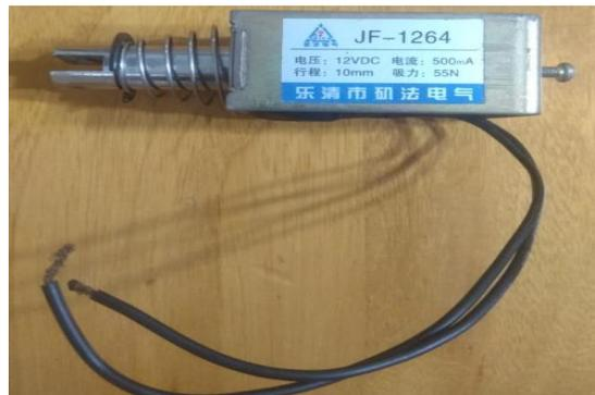
Figura 3. 6: Solenoide de 12 V para mecanismo de pateo
