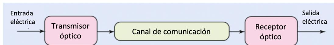
Figura 2. 2: Sistema de comunicación óptico genérico.
