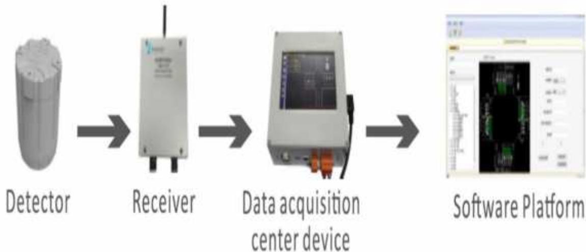
Figura 3. 5: Diagrama Sistema de Detección Vehicular WVD
