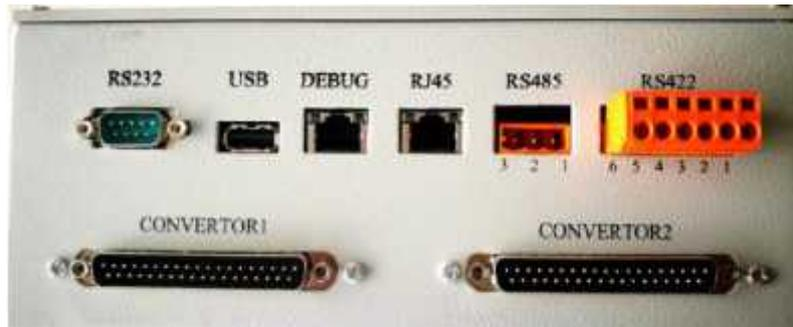
Figura 3.10: Conectores del Módulo procesador (DAC)
