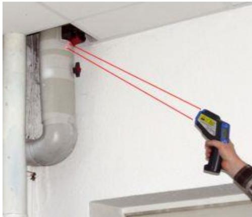
Figura 3. 4 Operación de termómetro infrarrojo
