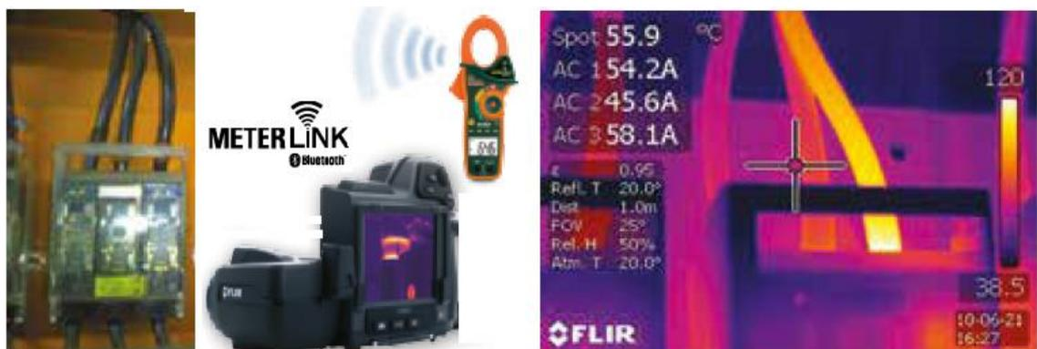
Figura 3. 18 Conexión de pinza amperimétrica con cámara FLIR T620
