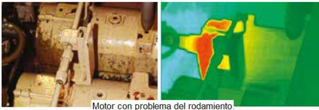
Figura 3. 24 Ejemplo de problema del rodamiento de un motor eléctrico
