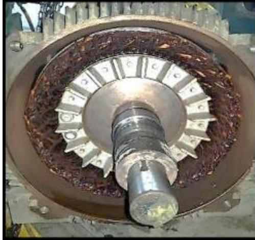
Figura 3. 31 Estator de motor de zaranda averiado
