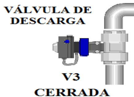
Figura 4.5: Válvula de descarga de agua
