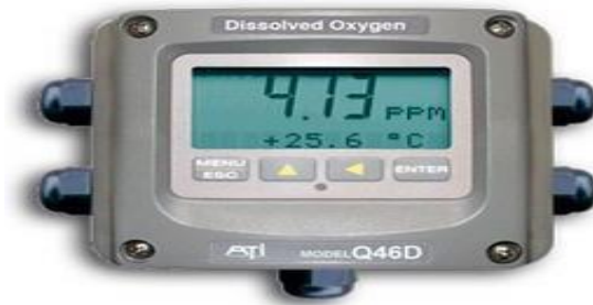
Figura 3.4: Sensor de Oxígeno disuelto en agua Fuente: (Mejoras Energéticas, 2018)
