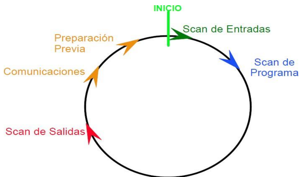
Figura 2.1: Ciclo de procesamiento de información del PLC
