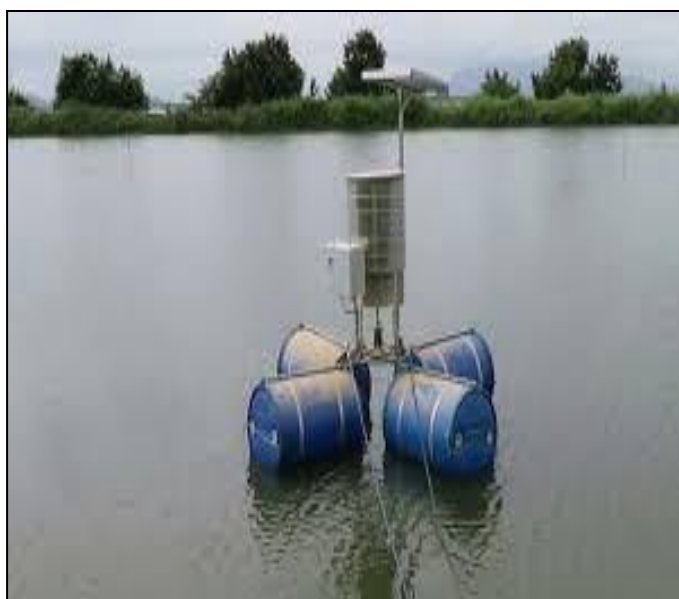
Figura 3.1: Motor de Abastecimiento de Alimento Fuente: (Robotilsa S.A., 2016)
