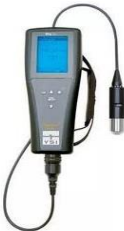
Figura 3.7: Transmisor de Salinidad Fuente: (YSI Pro30, 2019)
