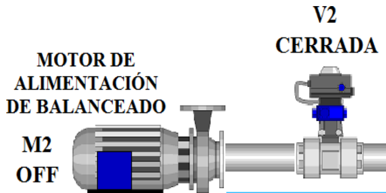
Figura 4.7: Motor y Válvula de Alimentación de Balanceado
