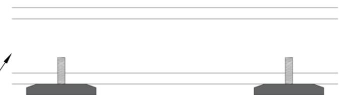
Fijación de topes de goma al tubo circular de acero galvanizado mediante tornillos de 1 pulgada.
