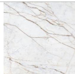
Figura 156: resina epoxi imitación mármol
