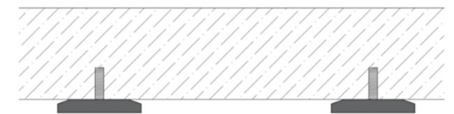
Fijación de toques de goma al tablero de aglomerado RH mediante tornillos de 1 pulgada.
