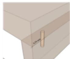
**Detalle 2:** Ensamblado con uniones a tope y tornillos autorroscantes cabeza plana de 3.50x25mm, 4 de diámetro en perforación guía y tapatornillos.
