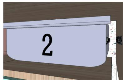
**Detalle 3:** Zócalo de 7cm de alto con tiras de pino de 3cm, ensamblado a unión de media madera con tornillos autorroscantes 4x50mm.
