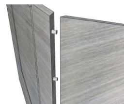
**Detalle 3:** Base de doble tablero de 15mm con calado en la superficie sobre estructura de tiras de madera laurel, unidas a ensamble de caja y espiga con tornillos autorroscantes de 4x50mm.
