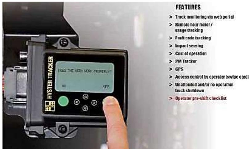
*Figura 3.8: Unidad de Control Telemático HYSTER TRACKER
