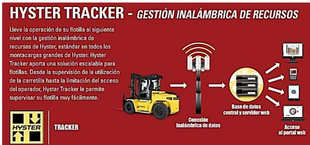
*Figura 3.7: Esquema de conectividad del sistema HYSTER TRACKER
