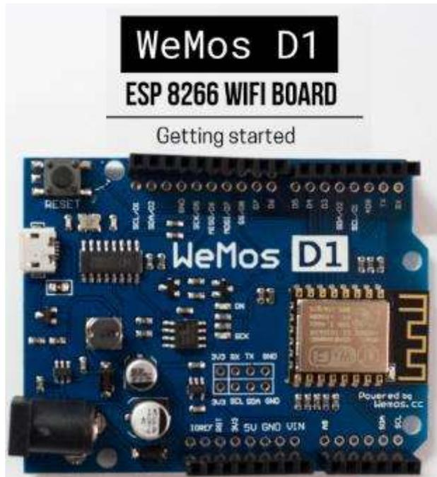
*Figura 3.15: Módulo ESP 8266 WIFI Board*
