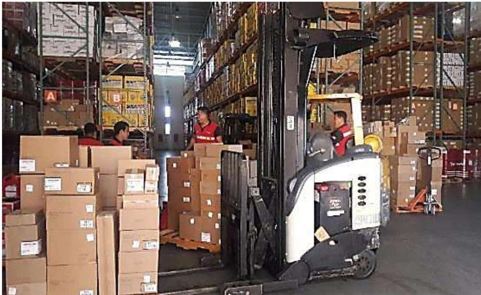
*Figura 2.1 Montacargas Pasillo Angosto Crown
