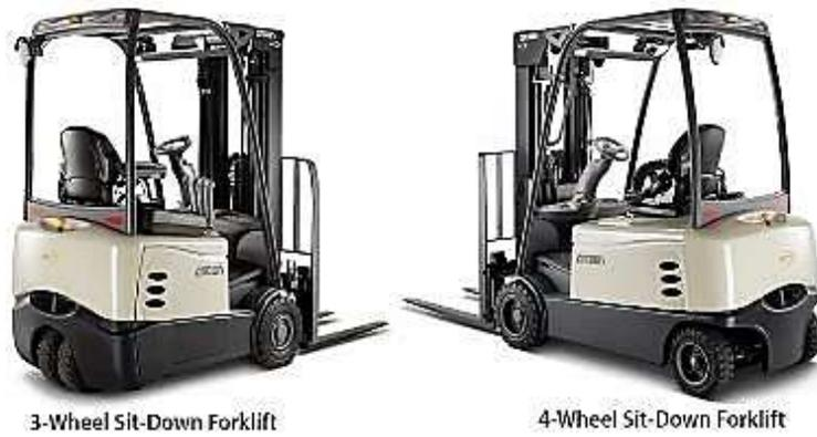
*Figura 2.2: Montacargas Contrabalanceados Crown SC6000
