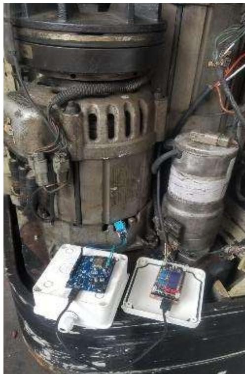
*Figura 3.32: Captación de temperatura del motor de tracción con el sensor y Módulo WiFi*
