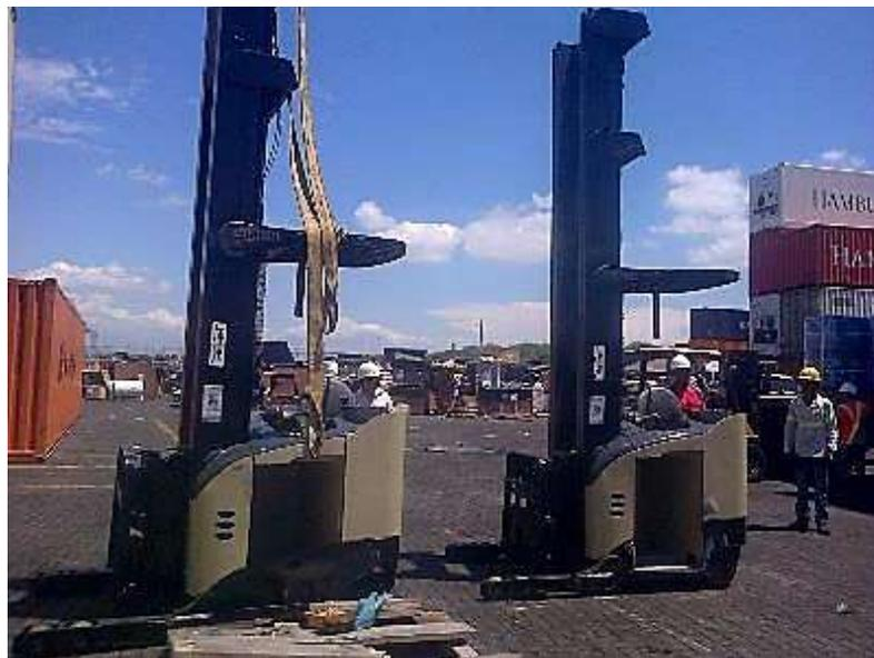
*Figura 2.3: Montacargas Pasillo Angosto Crown RD5200
