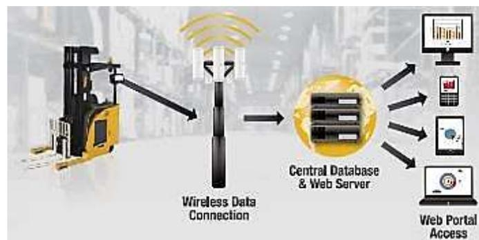
*Figura 3.6: Esquema de funcionamiento de Yale Vision*
