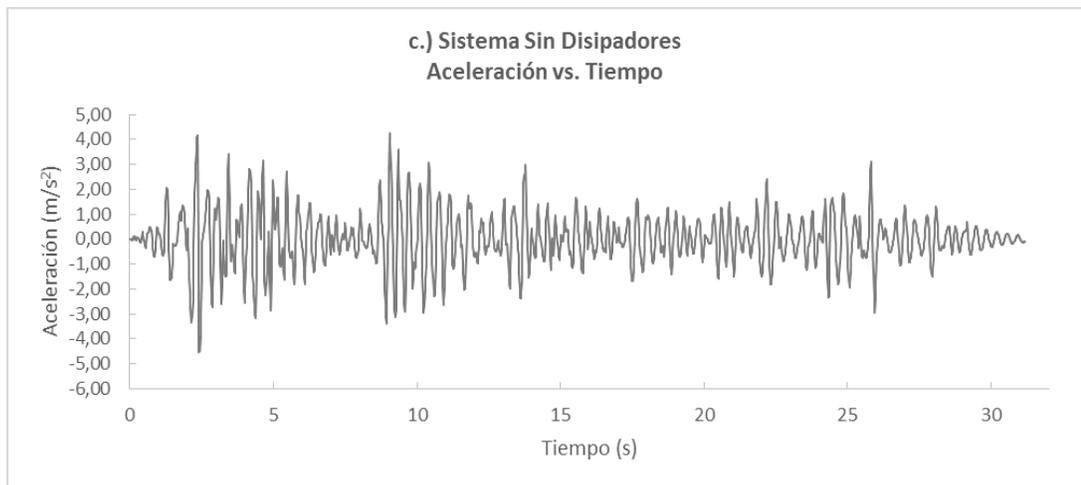
Figura 4.8.3.1 Respuesta del Sistema Sin Disipador a.) Desplazamiento vs. Tiempo, b.) Velocidad vs. Tiempo y c.) Aceleración vs. Tiempo.
