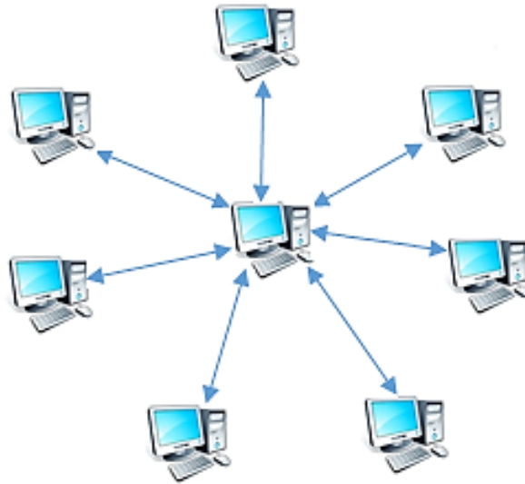
Figura 2. 9: Topología en Estrella. Fuente: Elaboración propia.
