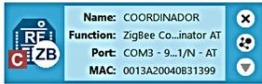
Figura 3. 6: Etiqueta donde se muestra la configuración del módulo XBee PRO S2 Fuente: Elaboración propia.
