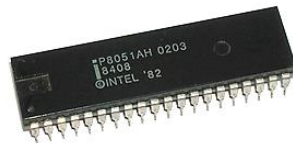
Figura 2. 22: Microcontrolador INTEL 8051. Fuente: (Sánchez, 2011)
