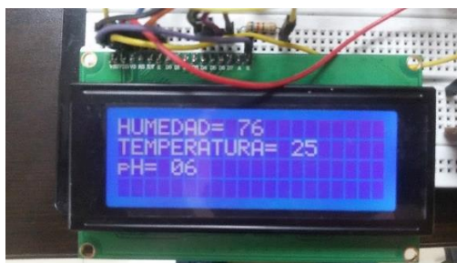
Figura 3. 24: Se muestra LCD con valores de parámetros en detalle. Fuente: Elaboración propia.
