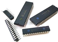
Figura 2. 25: Microcontroladores familia PIC . Fuente: Elaboración propia.
