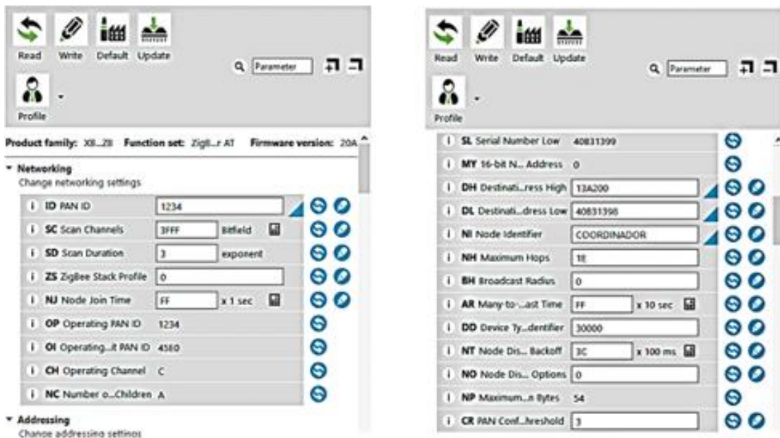
Figura 3. 7: Pestañas de configuración parámetros de los módulos XBee PRO S2 Fuente: Elaboración propia.
