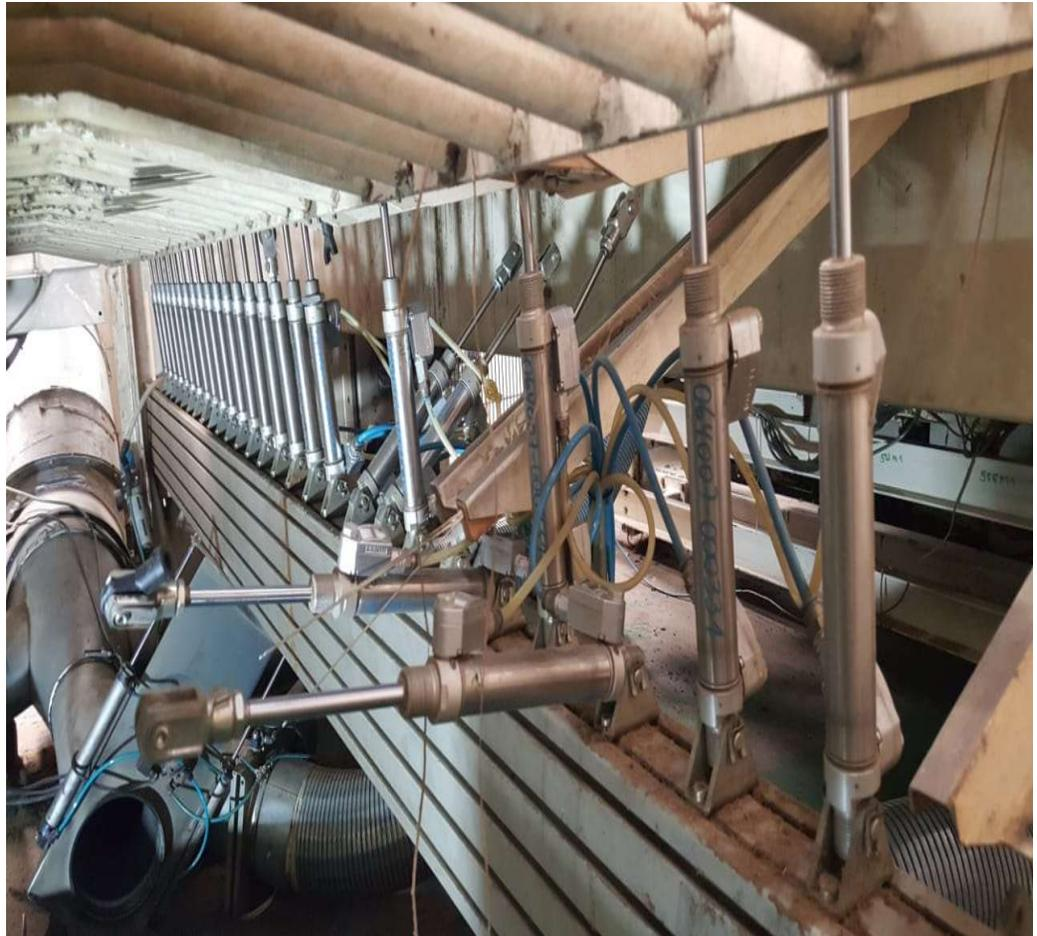
**Figura A.1.4:** *Cilindros neumáticos marca Festo de la cortadora longitudinal.*
