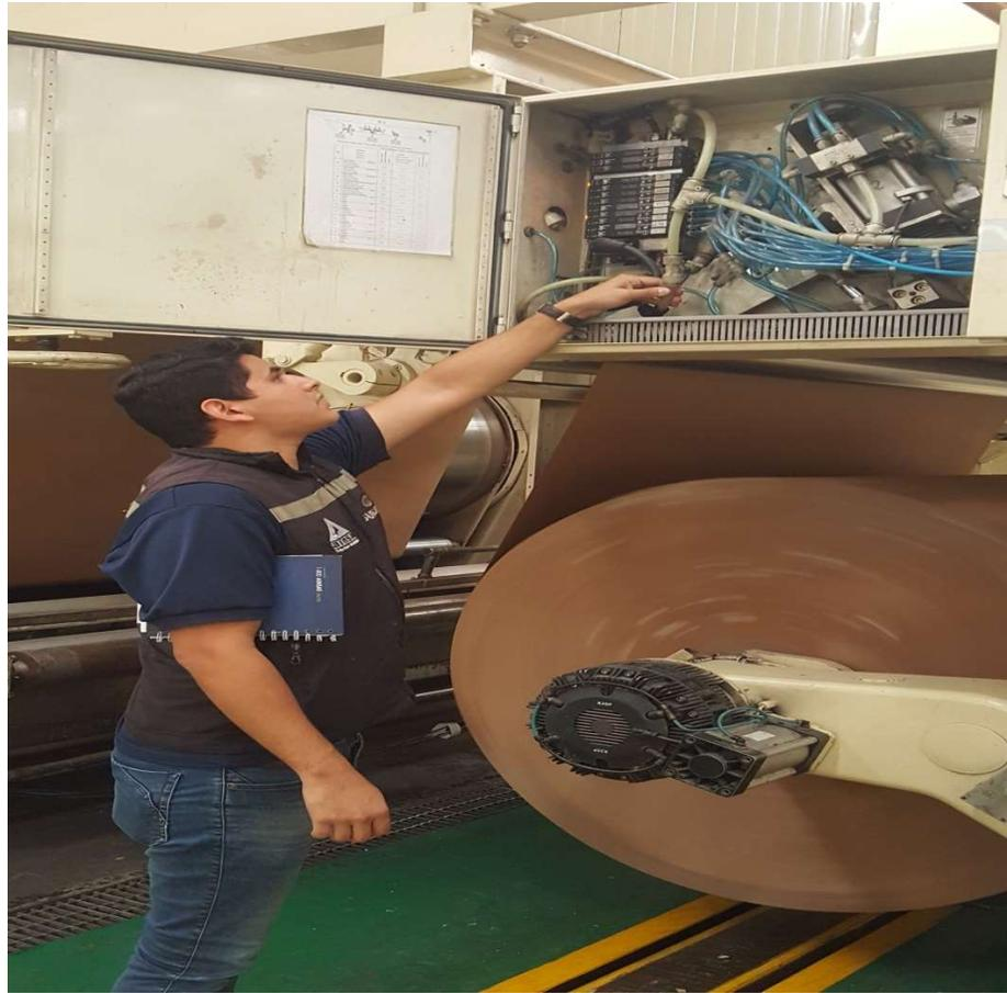
**Figura A.1.2:** *Bloque de válvulas Rexroth de la maquina empalmadora de bobinas*
