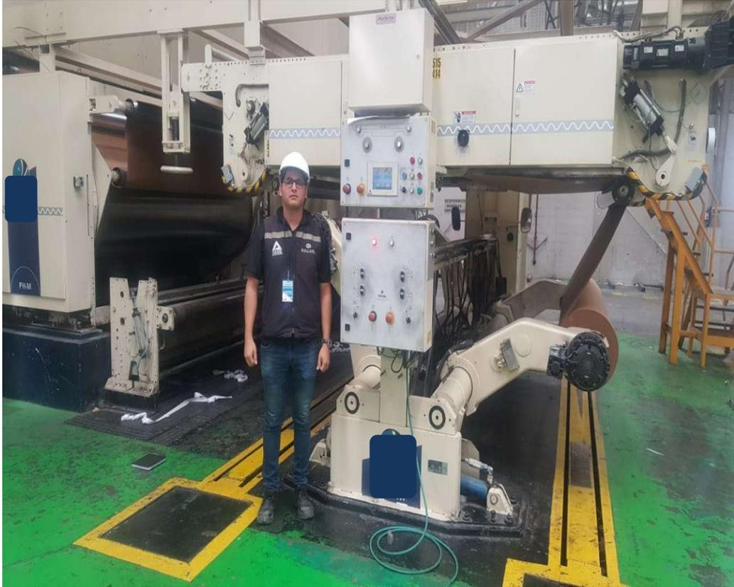
**Figura A.1.1:** *Maquina empalmadora de bobinas de cartón.*
