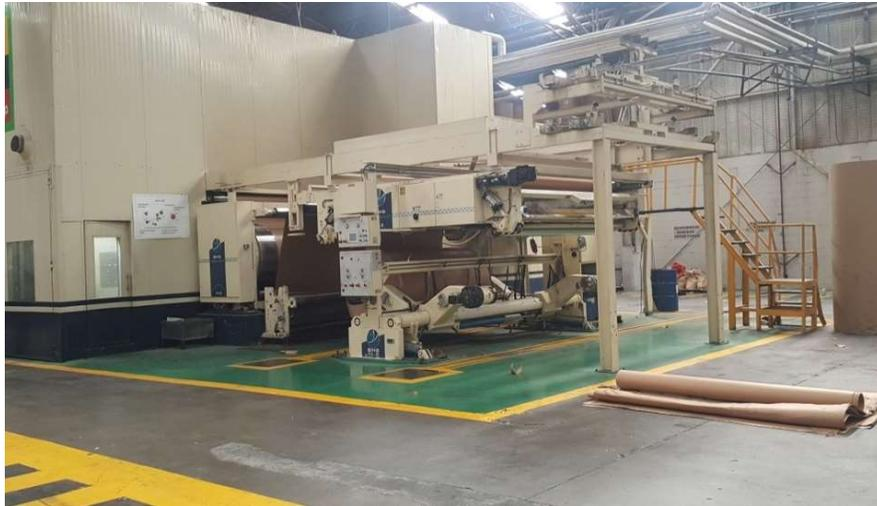
**Figura 3.5:** *Maquina empalmadora de bobinas de cartón.*
