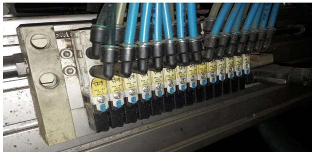
**Figura 3.11:** Bloque de válvulas 5/2 marca Aventics
