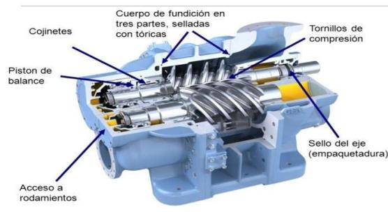
**Figura 2.3:** Partes de la unidad compresora de tornillo
