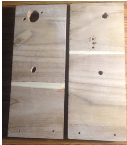
Figura 3.3 Soporte de Eje "x" Elaborado por: Autor (2019)
