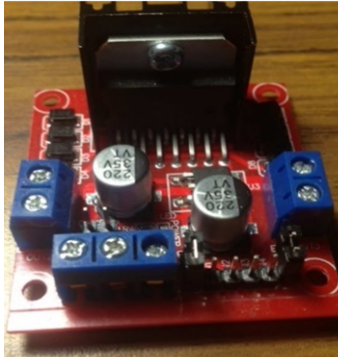
Figura 3.39 puente H DriverI298n Elaborado por: Autor (2019)
