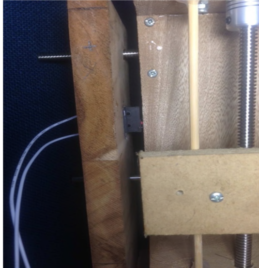
Figura 3.17 Sensor de final de carrera de eje X, pulsado por caja de Eje Z Elaborado por: Autor (2019)
