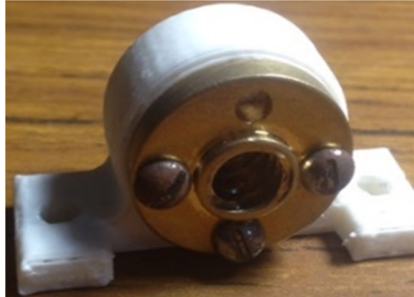
Figura 3.43 Chumacera fabricada en impresora 3D Elaborado por: Autor (2019)
