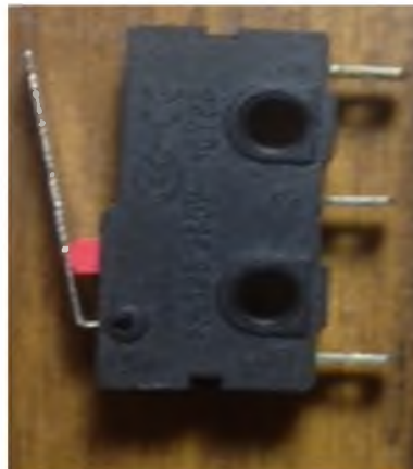
Figura 3.40 Sensor Final de carrera Elaborado por: Autor (2019)
