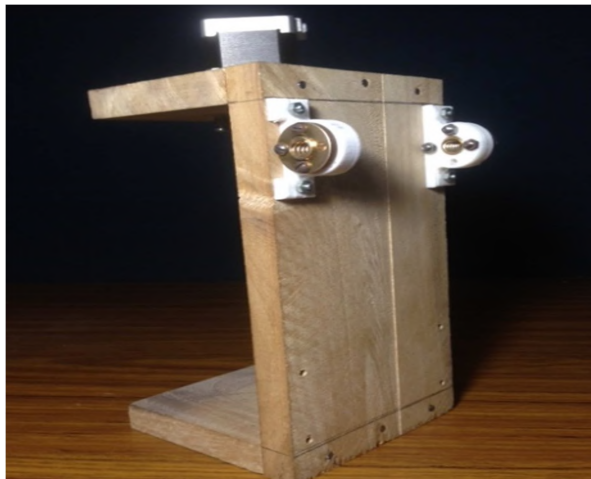
Figura 3.14 Chumaceras desplaza Eje X Elaborado por: Autor (2019)
