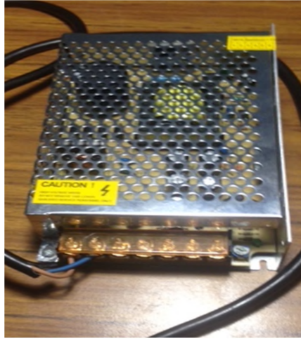
Figura 3.41: fuente con cables de toma de 120 voltios Elaborado por: Autor (2019)
