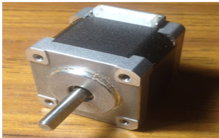
Figura 3.38 Motor Nema 17 Elaborado por: Autor (2019)
