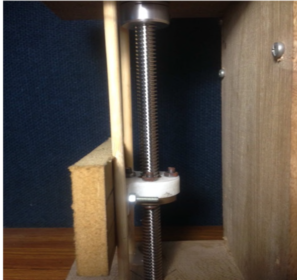
Figura 3.15 Chumacera desliza Eje Z Elaborado por: Autor (2019)
