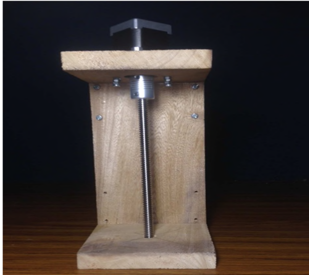
Figura 3.13 Eje Z completo Elaborado por: Autor (2019)
