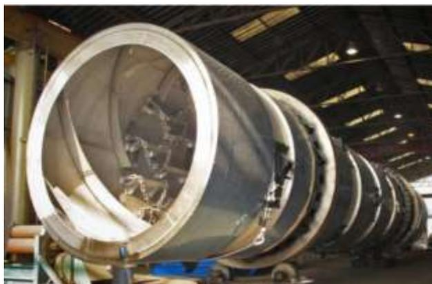
Figura 3. 7 Secador Rotativo
