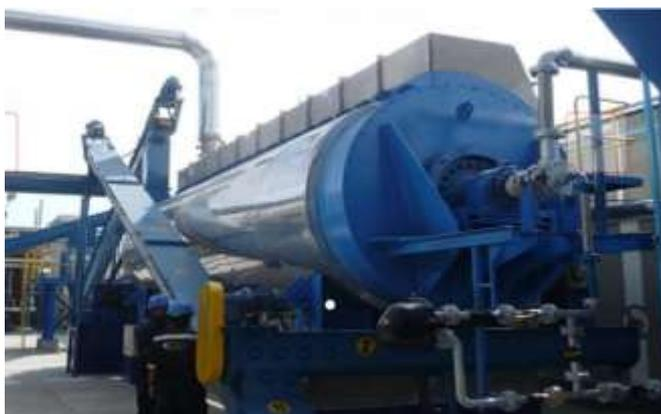
Figura 3. 8 Secador Rotadiscos
