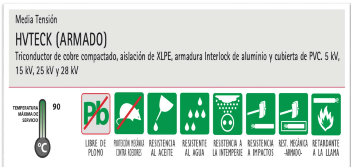
Figura 4. 2 Características de cables de media tensión (HVTECK) armado Fuente: (General cable, 2018)
