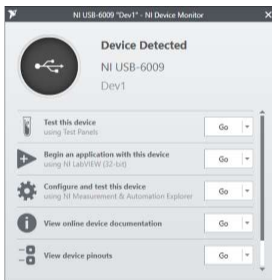
Figura 3. 16: Ventana de configuración para dispositivos NI USB-6009 Elaborado por: Autor
