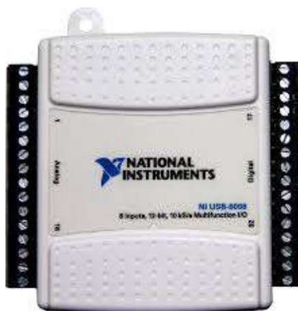
Figura 3. 1: Dispositivo de adquisición de datos de National Instrument. Elaborado por: Autor
