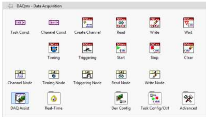
Figura 3. 17: Ventana para configuración de adquisición de datos usando DAQmx. Elaborado por: Autor
