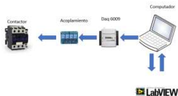
Figura 3. 10: Diagramas de bloques del control eléctrico de la aplicación práctica 1. Elaborado por: Autor
