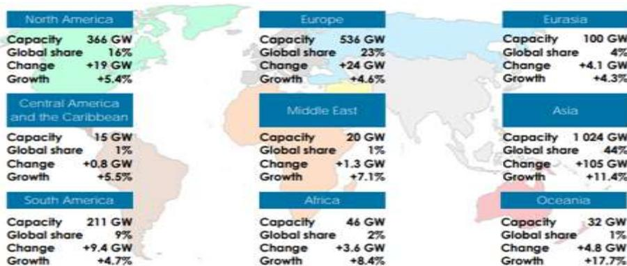
Figura 2. 2 Estadísticas de capacidad instalada por energía renovable a nivel global
