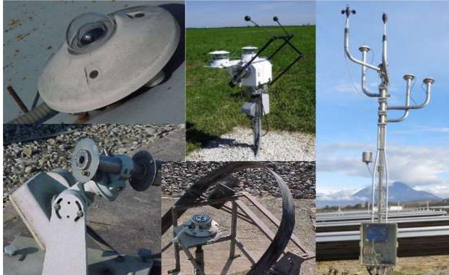
Figura 3. 24 Elementos de medida de radiación solar
