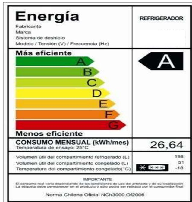
Etiqueta de Eficiencia Energética de un refrigerador
