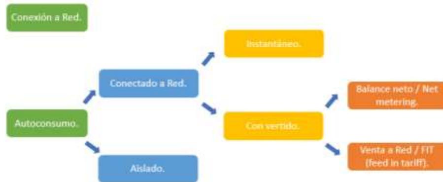
Figura 3. 35 Clasificación de los sistemas fotovoltaicos.
