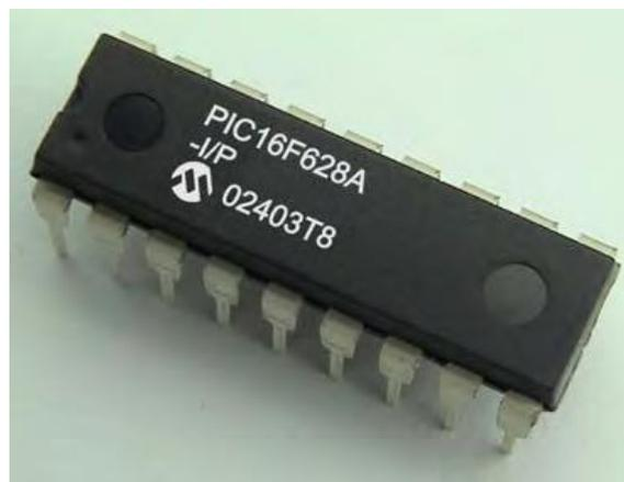
Figura 2. 14: El microcontrolador PIC de la gama 16F628A
