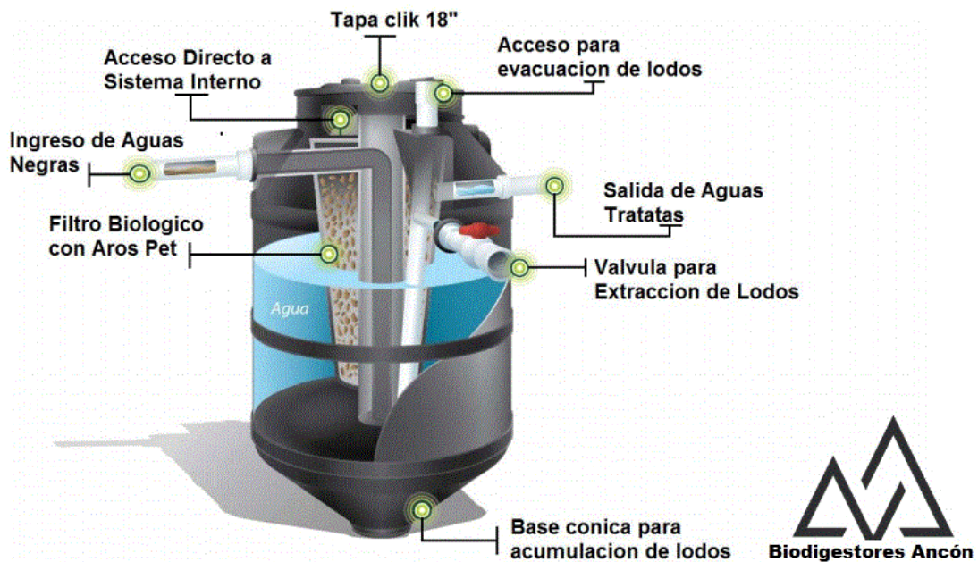
Figura No.29 Detalle del funcionamiento del biodigestor
