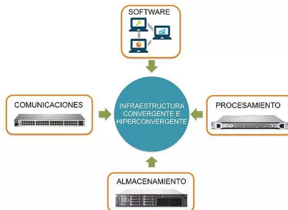
Figura 9. Estructura de Hiperconvergencia. Recuperado de: https://hiperconvergencia.mx/2017/12/29/como-funciona-la-hiperconvergencia-en-el-negocio/
