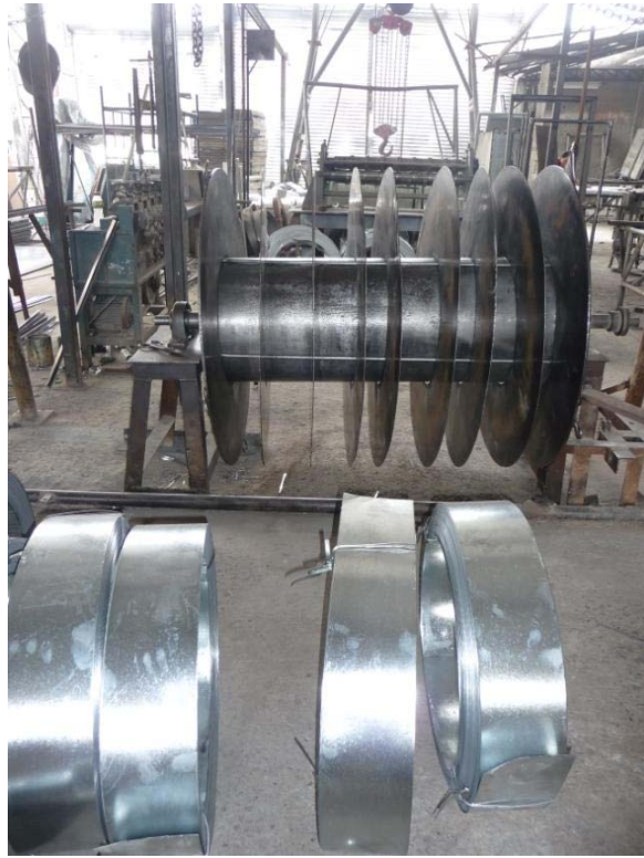
PROCESO DE CORTE DE LA BOBINA EN FLEJES
