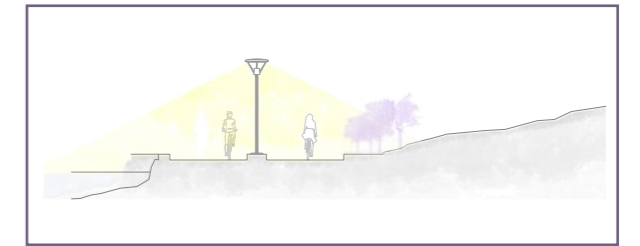
Diagrama # 8, Corte CC muestra el radio de luz de las luminarias en ciclovía disminuido por vegetación.
