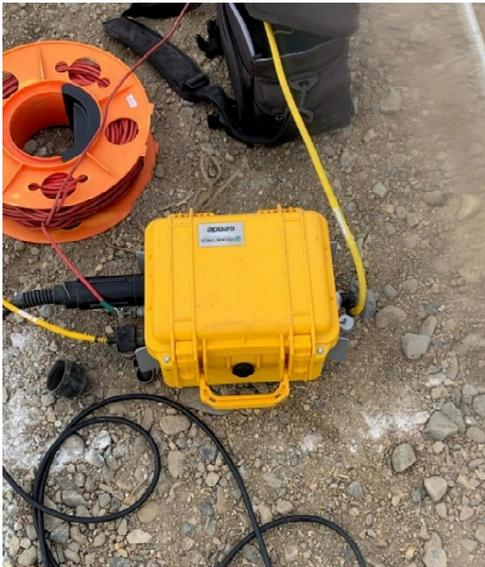
Figura 4. Sismógrafo, Geode y batería.
