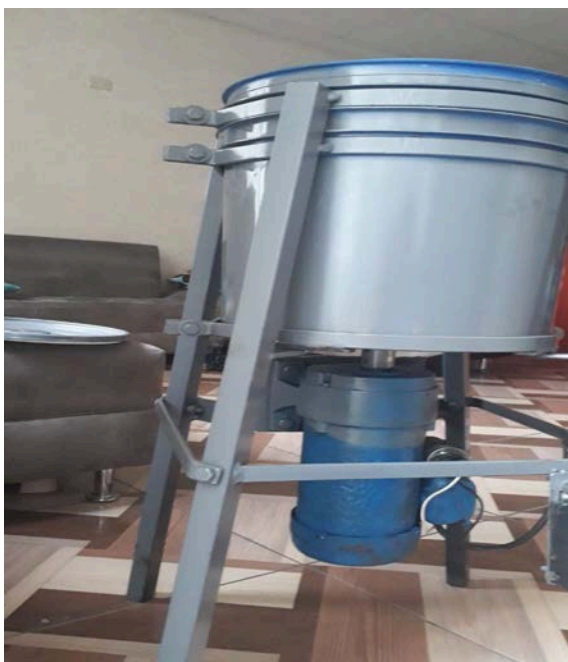
Ilustración 18 Digestor de alta tasa
