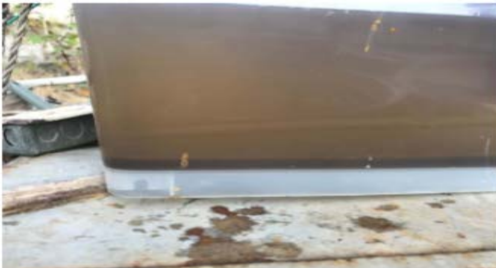
Ilustración 14 Tanque de mezcla rápida con 50 mg/l de Cloruro Férrico de concentración
