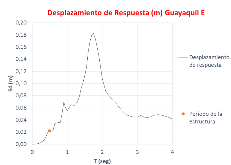
Ilustración 84. Valor Sd para edificio ECU-911 de Samborondón.
