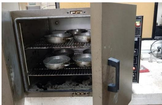
**Figura 3.1 Bandejas con agregados dosificados en el horno**
