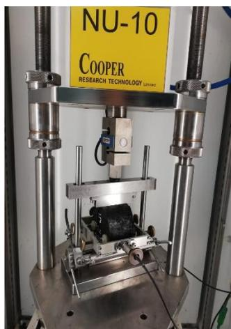
**Figura 4.14 Medición de módulo de rigidez con equipo NAT**
