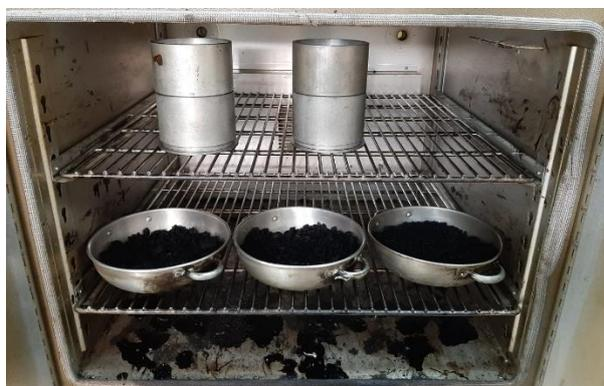
**Figura 3.4 Muestras de mezcla asfáltica en el horno**
