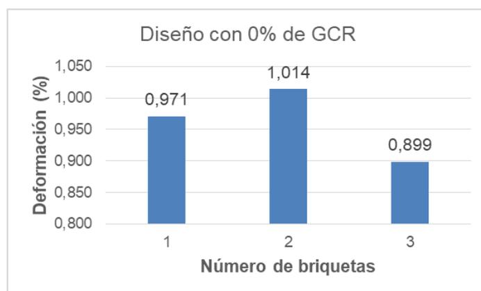
**Figura 4.20 Variación de la deformación permanente (Creep) en el diseño referencial con 0% de GCR**
