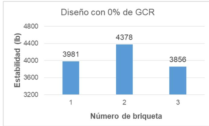
**Figura 4.2 Variación de la estabilidad en el diseño referencial con 0% de GCR**
