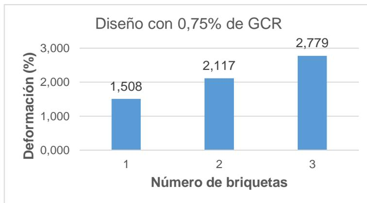
**Figura 4.21 Variación de la deformación permanente (Creep) en el diseño con 0.75% de GCR**
