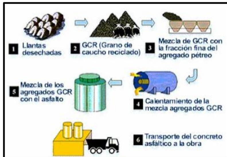
**Figura 2.5 Proceso adición GCR por vía seca (Castro & Diaz, 2017)**
