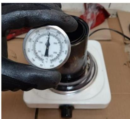
**Figura 3.2 Verificación de temperatura en el recipiente de asfalto**
