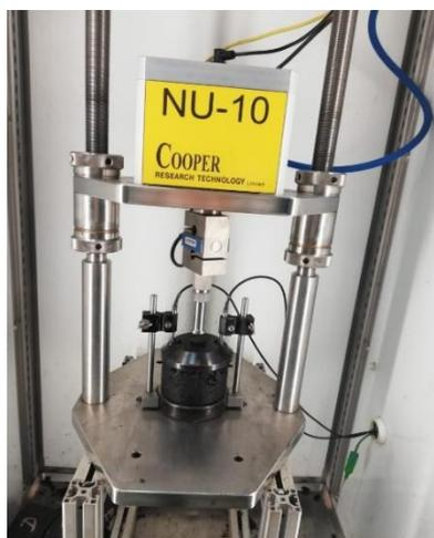
**Figura 4.19 Ensayo Creep con equipo NAT**
