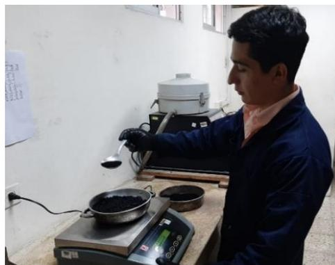
**Figura 3.8 Adición de GCR a la mezcla caliente**
