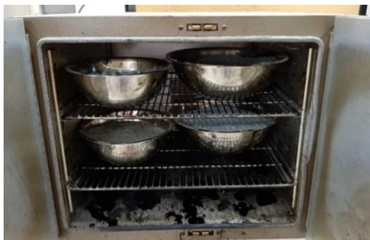
**Figura 3.6 Secado de los agregados en horno**
