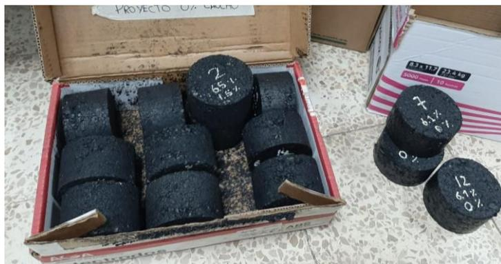
**Figura 3.9 Briquetas identificadas para control de las mismas**
