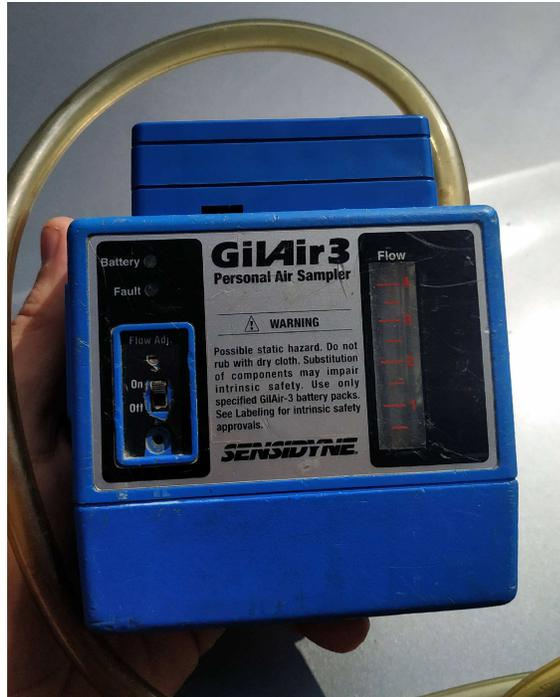
*Ilustración 19 Bomba de muestro portatil GilAir3*
