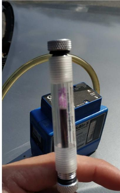
*Ilustración 20 Tubo de muestreo con carbón activado.*
