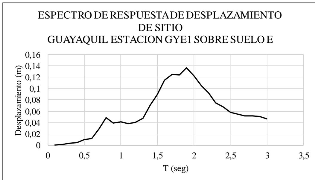
*Ilustración 59. Espectro de respuesta de desplazamiento de sitio, estación GYE1 norte-sur, sobre suelo tipo E.*
