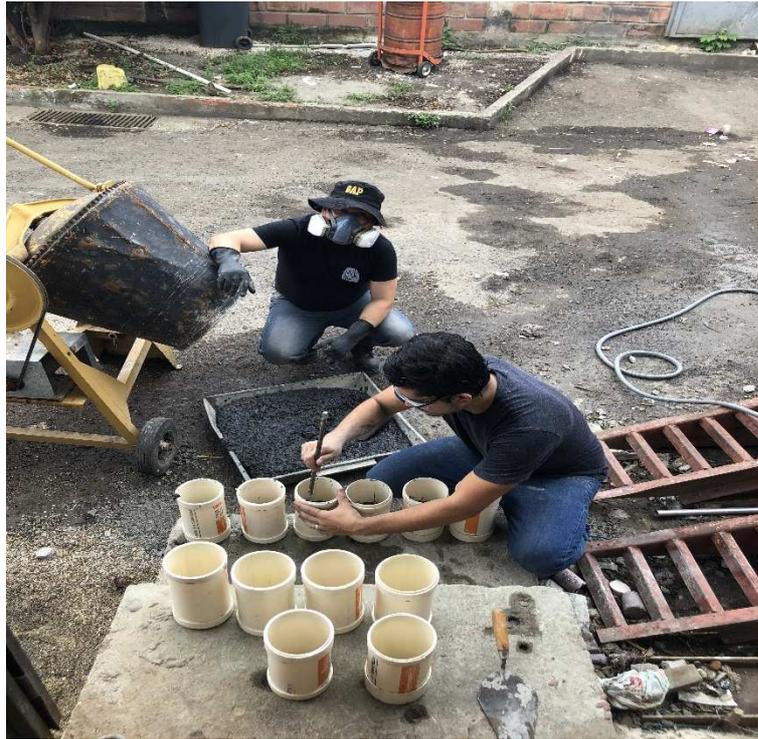
**Ilustración 18: Golpes con varilla de acero a la mezcla para quitar aire.**
