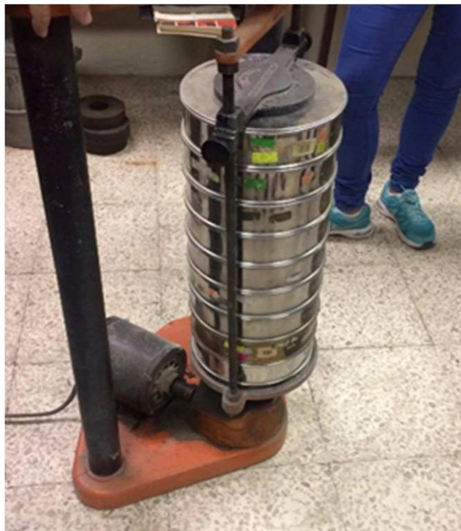
**Ilustración 6: tamices en agitador mecánico. Fuente: Autor**
