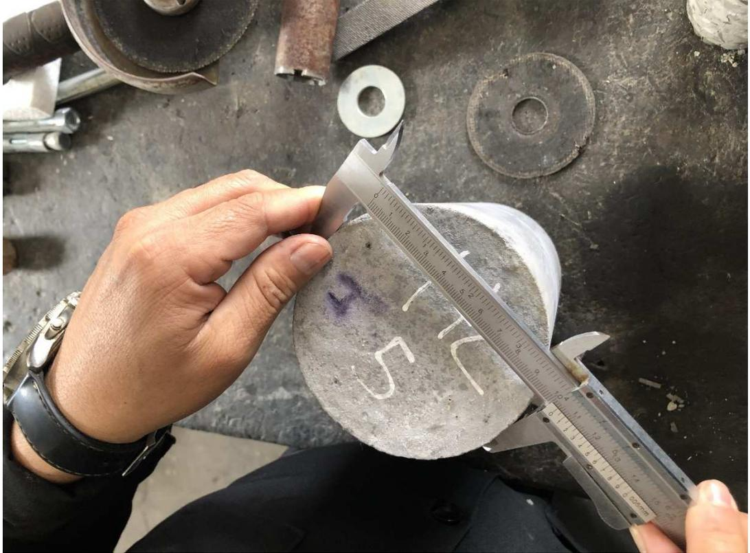
**Ilustración 32: Medición de diámetro de la probeta. Fuente: Autor**
