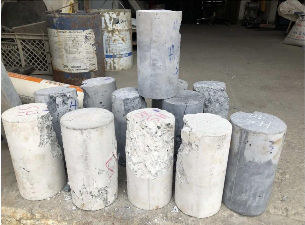
**Ilustración 35: Probetas ensayadas en la máquina de compresión. Fuente: Autor**
