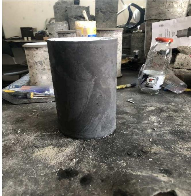
**Ilustración 22: Desmolde de cilindro de hormigón con CBCA. Fuente: Autor**
