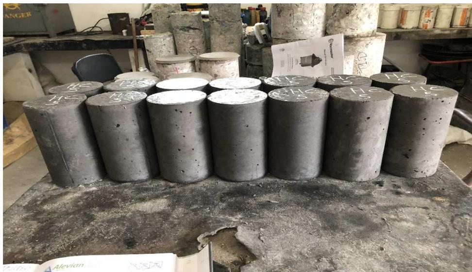
**Ilustración 23: Cilindros, luego de desmoldarlos. Fuente: Autor**
