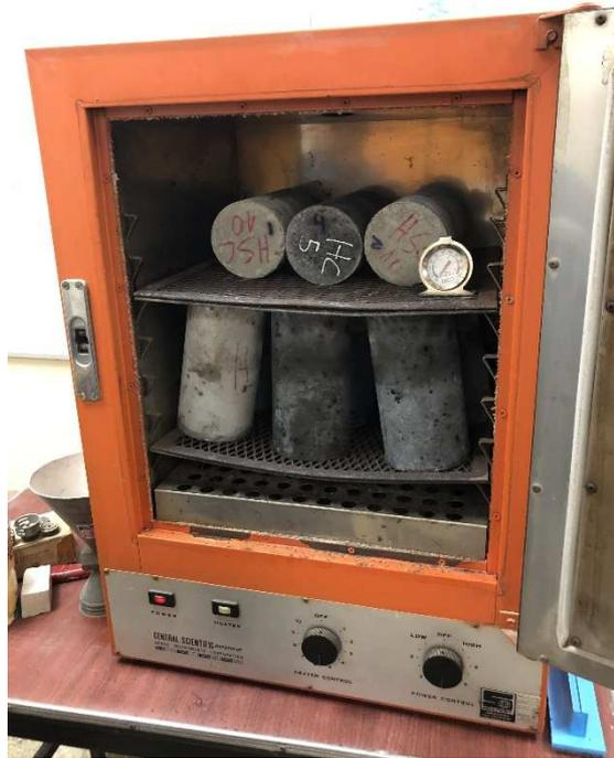
**Ilustración 29: Probetas en el horno a 105 °C. Fuente: Autor**
