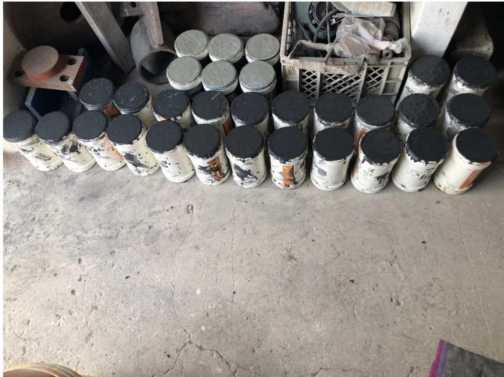
**Ilustración 21: Cilindros de hormigón simple y hormigón con CBCA. Fuente: Autor**
