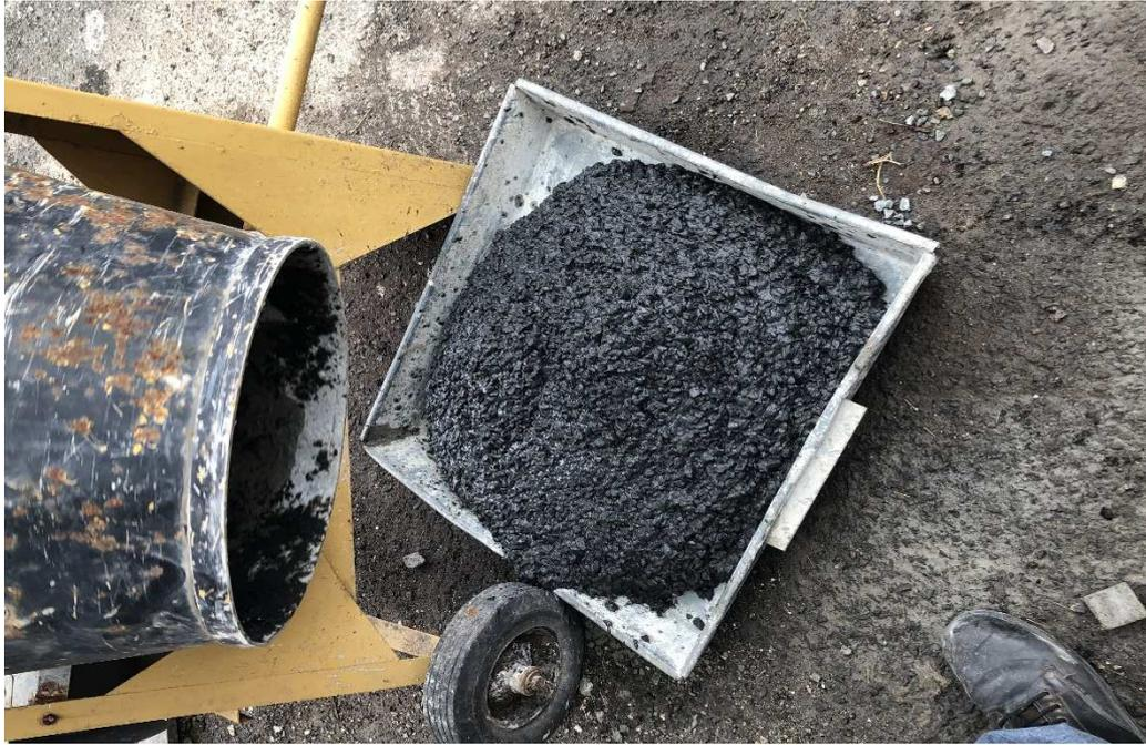
**Ilustración 16: Mezcla de hormigón con CBCA. Fuente: Autor**
