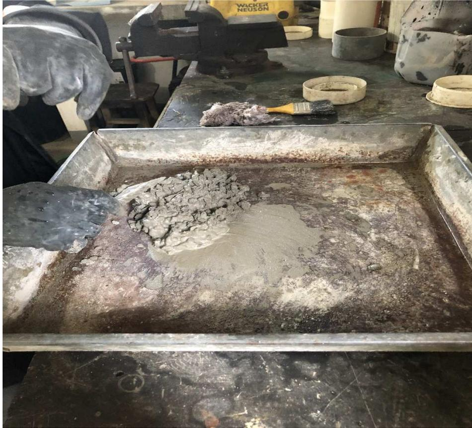
**Ilustración 9: Ensayo para dosificar hormigón. Fuente: Autor**
