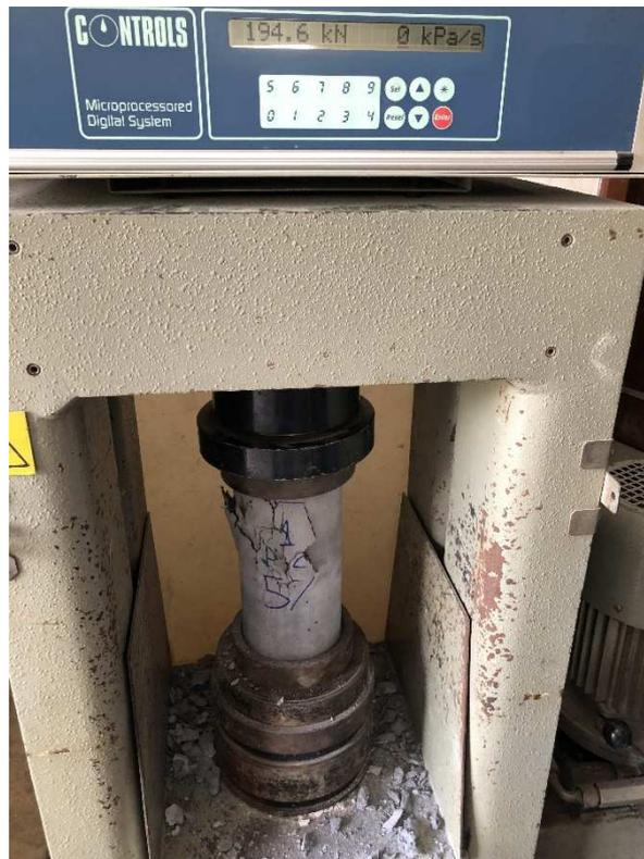
**Ilustración 34: Rotura de probeta. Fuente: Autor**
