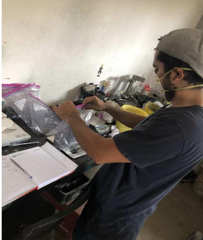
**Ilustración 8: Pesaje de la muestra en tamiz No.100. Fuente: Autor**
