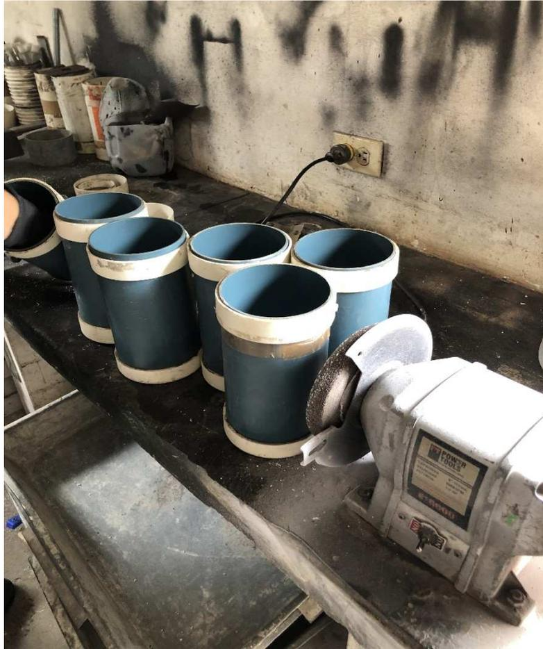
**Ilustración 10: Elaboración de cilindros para moldeo. Fuente: Autor**
