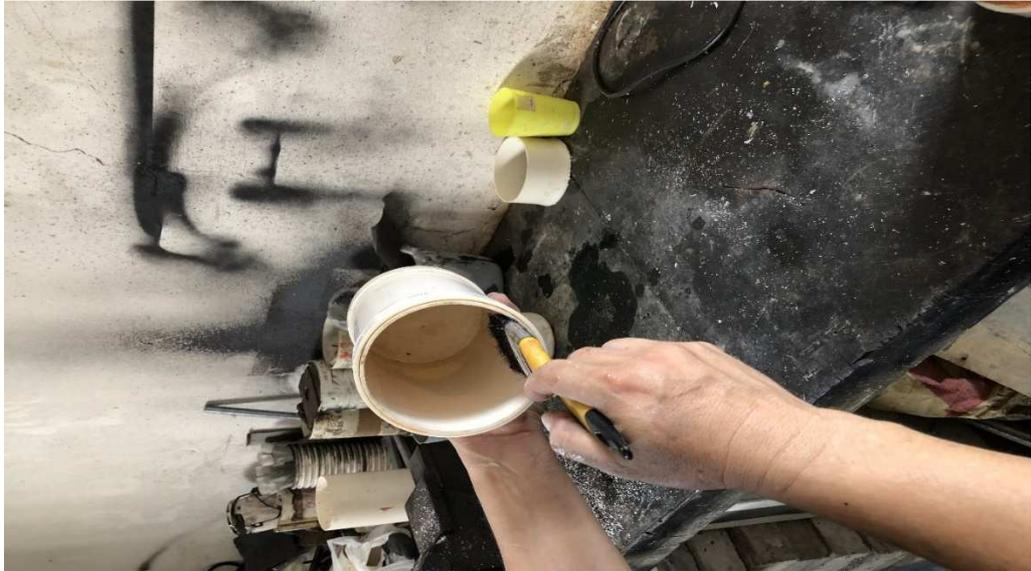
**Ilustración 14: Preparación de cilindros con aceite quemado. Fuente: Autor**
