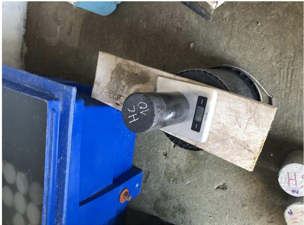
**Ilustración 31: Pesaje probeta saturada superficialmente seca. Fuente: Autor**
