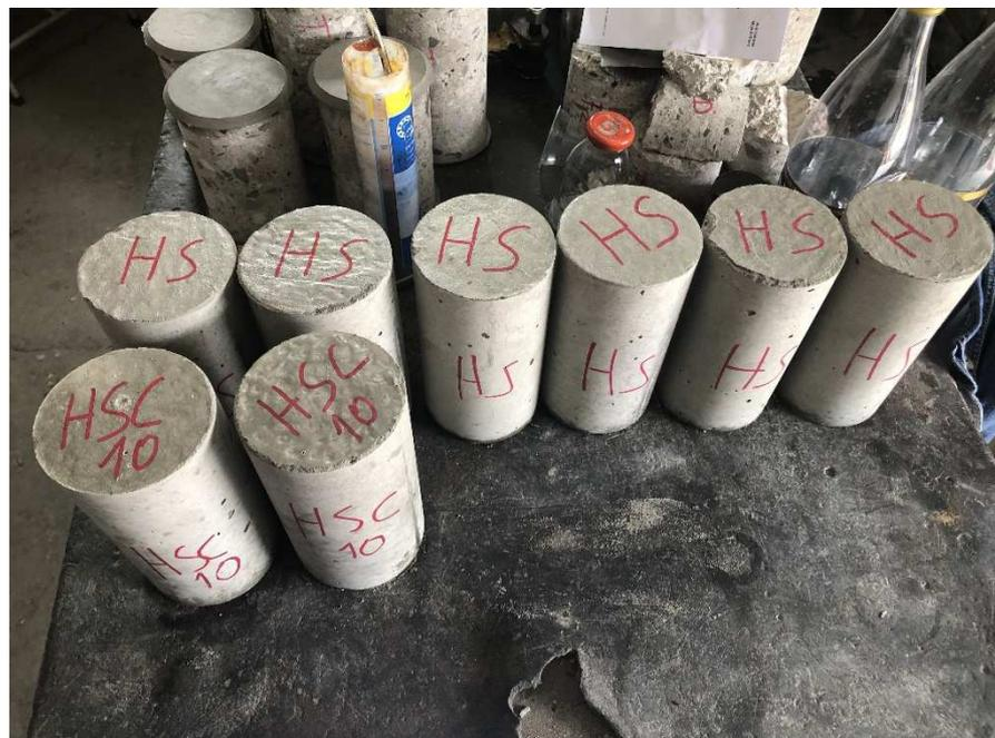
**Ilustración 25: Nomenclatura hormigón simple. Fuente: Autor**
