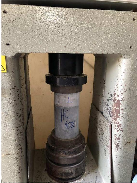
**Ilustración 33: Probeta en la prensa. Fuente: Autor**
