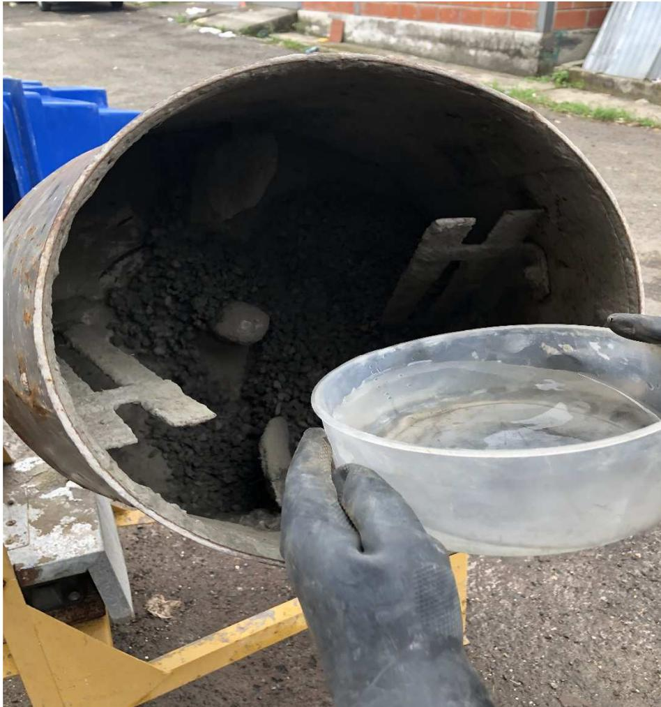
**Ilustración 13: Materiales en la hormigonera. Fuente: Autor**
