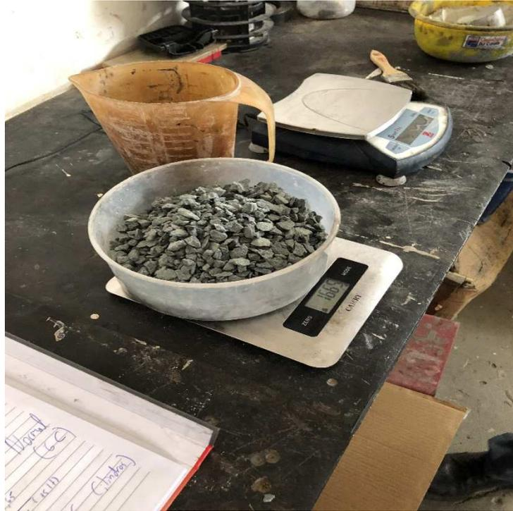
**Ilustración 11: Pesaje del agregado grueso para la mezcla. Fuente: Autor**
