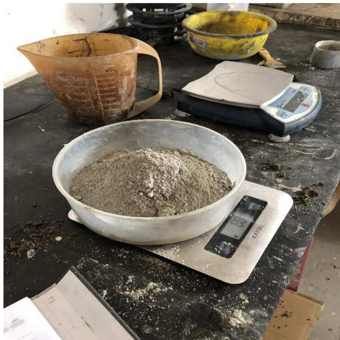
**Ilustración 12: Pesaje del cemento para la mezcla. Fuente: Autor**
