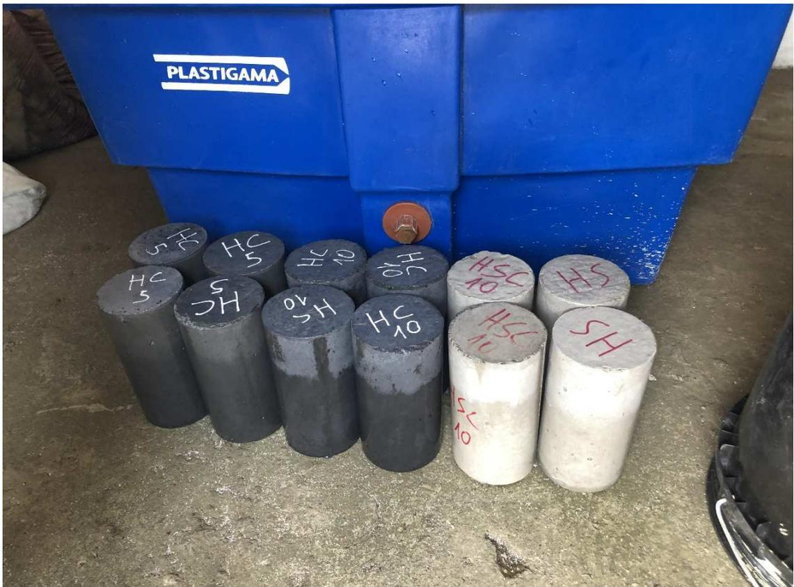
**Ilustración 28: Probetas tomadas de la piscina de curado. Fuente: Autor**
