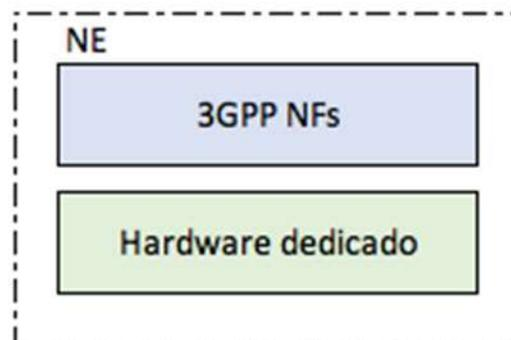
Figura 2. 22: Componentes de un elemento de red convencional
