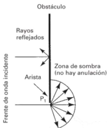
Figura 2.5. Difracción de ondas electromagnéticas – Efecto filo de cuchilla.
