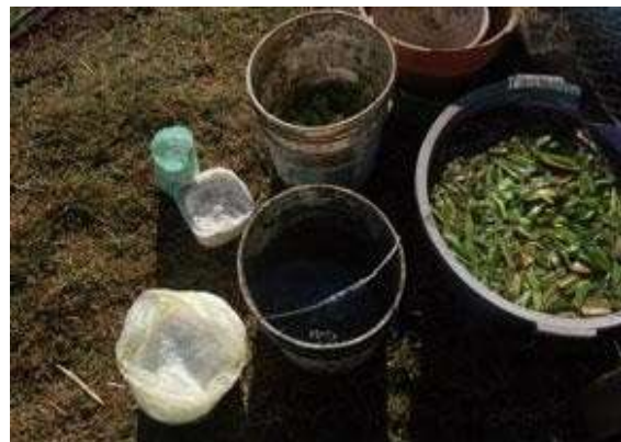
Aquí los ingredientes para la impermeabilización: Baba de Nopal (15 ltr), cal (5kg) y sal del mar (1 kg)
