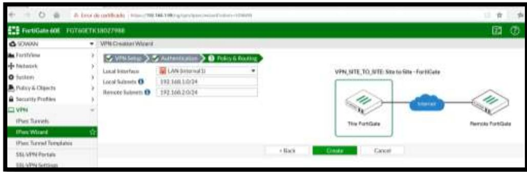
Figura 3. 39 Configuración de la VPN sección Policy & Routing.
