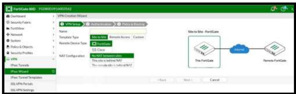
**Figura 3. 23 Pantalla de IPsec Wizard sección VPN Setup**
