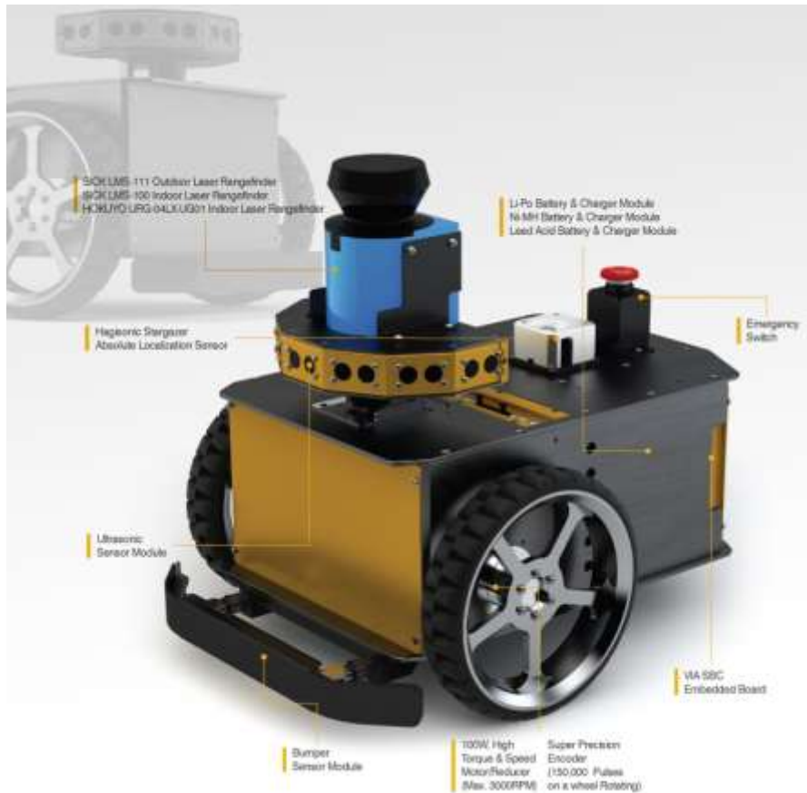
Figura 2. 15: Sensor SICK LMS 100 implementado en un robot móvil. Fuente: (Robots in Search, 2012)
