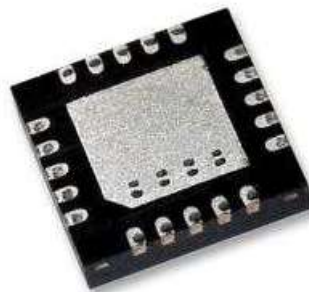
Figura 2. 11: Dispositivo sensor táctil capacitivo de Microchip.
