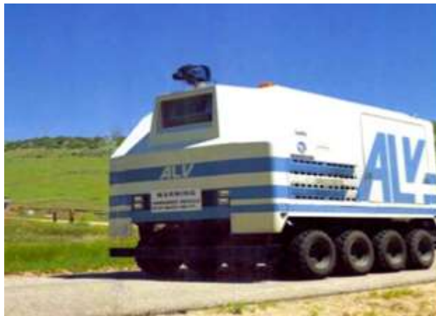
Figura 2. 1: Vehículo autónomo terrestre financiado por DARPA en 1980. Fuente: (Stone et al., 2006)
