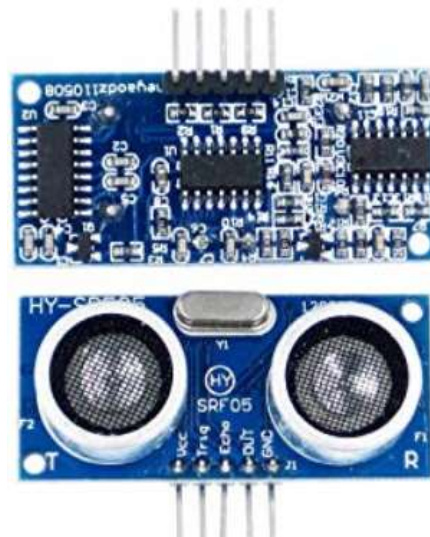
Figura 2. 16: Sensor ultrasónico SFR Fuente: (Restrepo Álvarez & Cardona Salazar, 2015)
