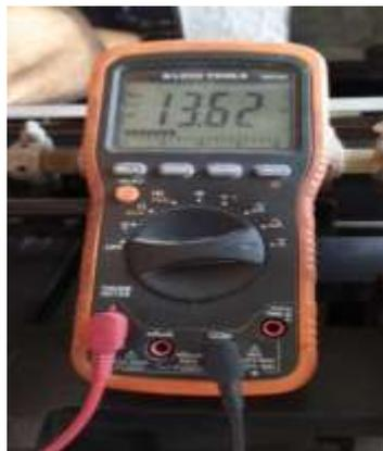
Figura 3.36: Medición de amperaje en plancha resistiva.
