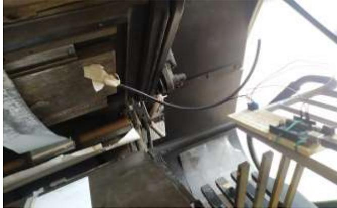
Figura 3.27: Obtención de datos de temperatura con sensor LM35.
