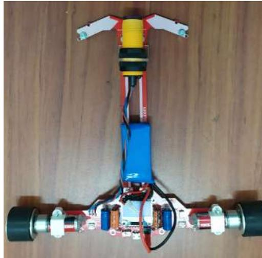
Figura 3. 30: Partes montadas en el robot seguidor de línea.
