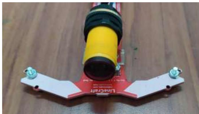
Figura 3. 32: Sensor frontal fotoeléctrico M18.
