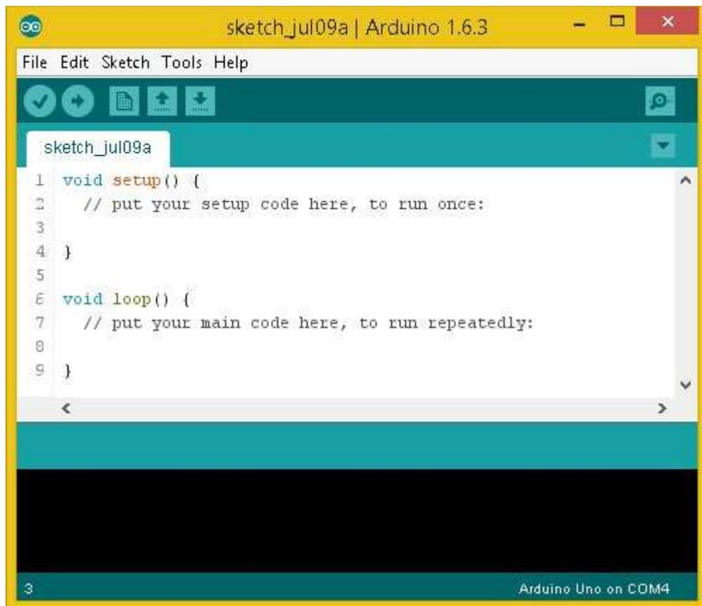
Figura 2. 16: Ventana principal de plataforma de programación Arduino IDE basado en C++.
