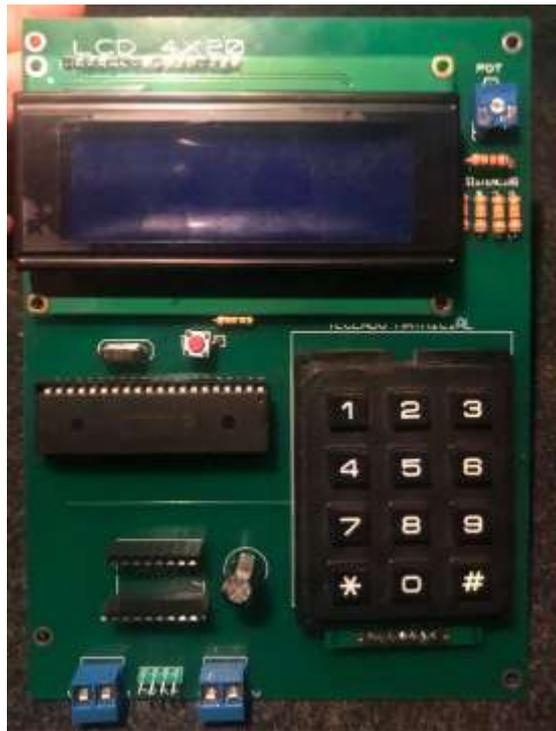
Figura 3. 35: Implementación del equipo que controla al sistema de microaspersión estereotáctica.
