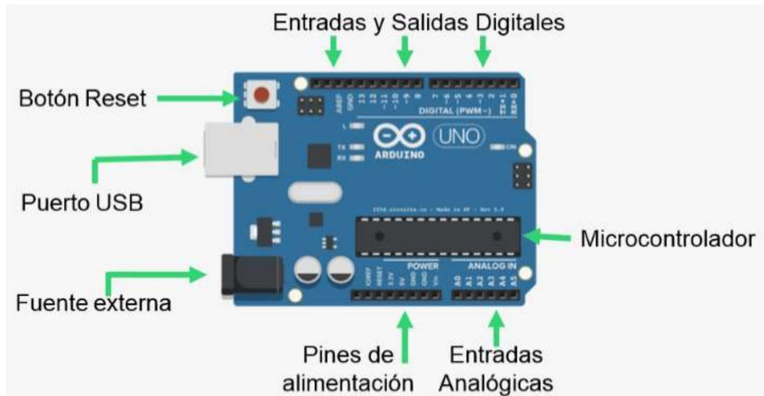
Figura 2.6 Principales partes de la placa de Arduino.
