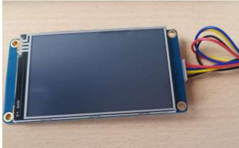
*Figura 2.10 Pantalla táctil Nextion de 3.2 pulgadas*
