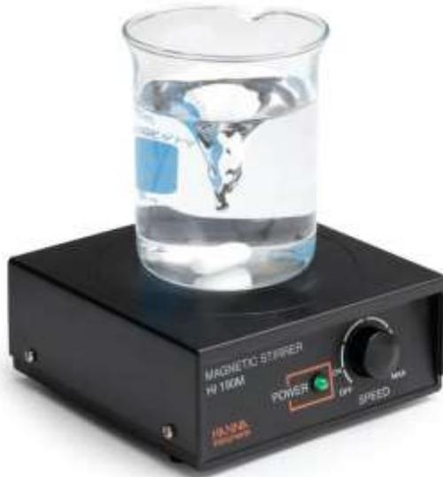
*Figura 2.15 Máquina de agitación magnética*
